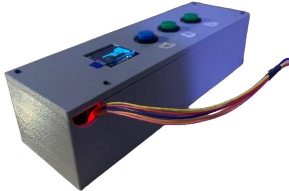
*Ilustración 45 - Lateral con hueco para salida de cables del motor*
