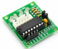
*Ilustración 5 - Módulo ULN2003*
