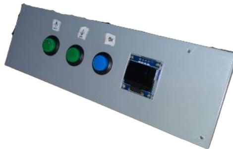
*Ilustración 46 - Tapa con los pulsadores y la pantalla colocados*
