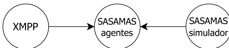
Figura 5.3: Grafo de dependencias de los módulos que intervienen en la ejecución del sistema SASAMAS.
