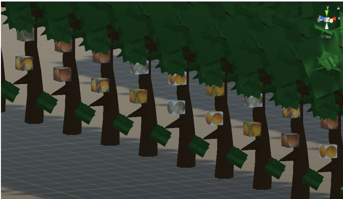
Figura 3.14: Varios naranjos con texturas aleatorias aplicadas en tiempo de ejecución a las naranjas, cargando las imágenes de la ruta especificada en el archivo map_config.json .
