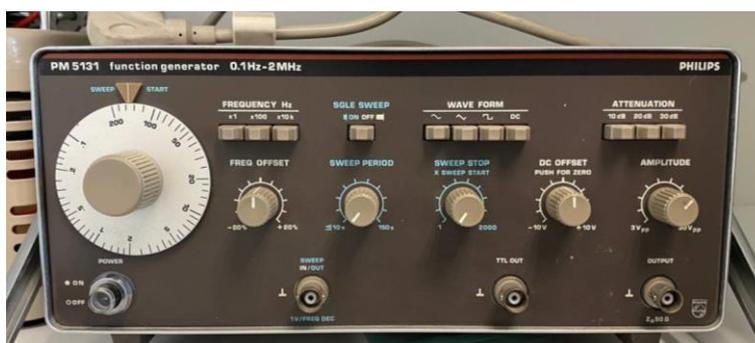
Figura 24. Generador Philips PM 5131.
