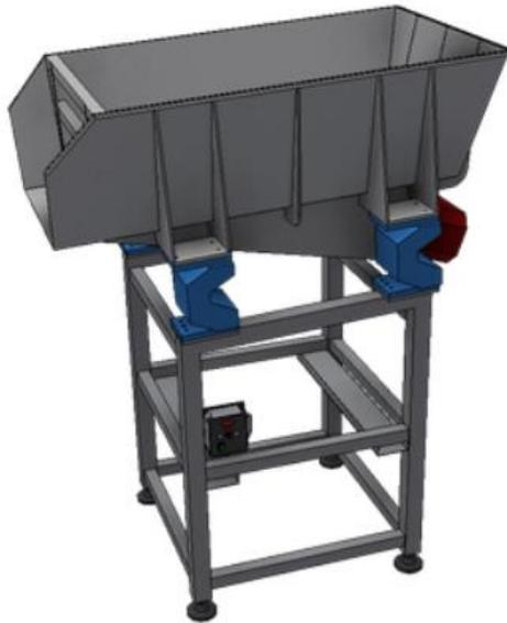
**Figura 13.** Diseño en 3D de una tolva vibratoria torbellino
