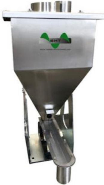
**Figura 10.** Dosificador de un único canal vibratorio
