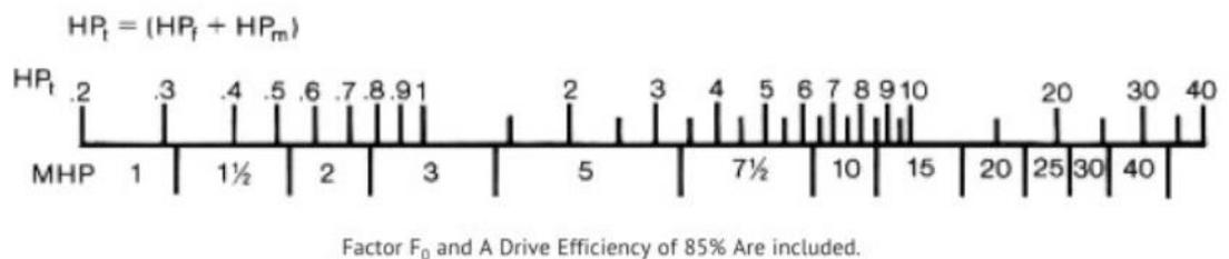
**Figura 53.** Grafica con los valores de potencia recomendada para el motor según la potencia total requerida para el transportador
