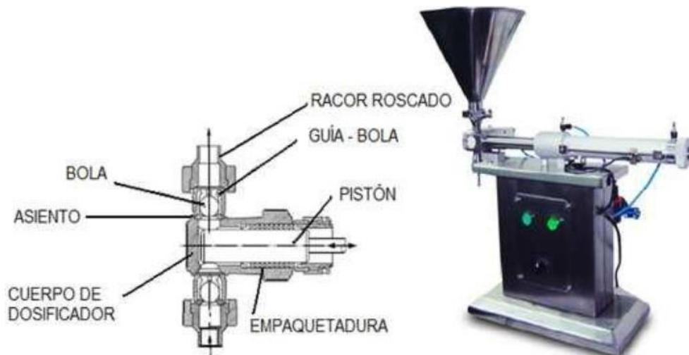
**Figura 2.** a) Esquema simplificado de un sistema dosificador con bomba dosificadora y sus componentes principales, b) Ejemplo real de una máquina dosificadora de pistón.
