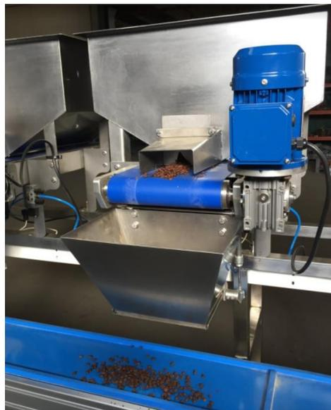
**Figura 15.** Alimentador de banda industrial con un depósito instalado en la parte superior y una tolva en la parte inferior
