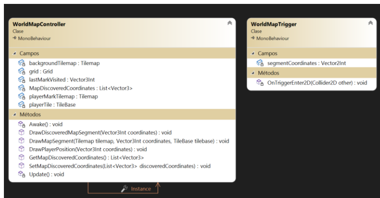
Figura 84: diagrama de clases del sistema de mapas
