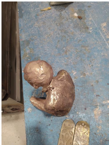
Fig. 82. Corte y repaso de bebederos.
