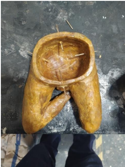
Fig. 76. Inserción de varillas de bronce para la sujeción del núcleo.
