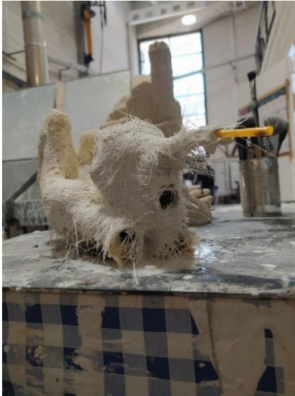
Fig. 83. Rotura de la cáscara cerámica. Soldadura de la cáscara cerámica con soplete.
