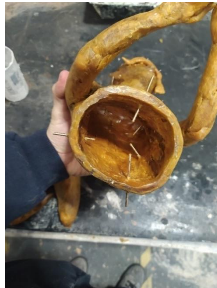
Fig. 74. Inserción de varillas de bronce para la sujeción del núcleo.
