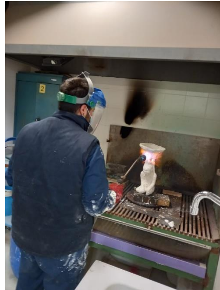
Fig. 84. Soldadura de la cáscara cerámica con soplete.
