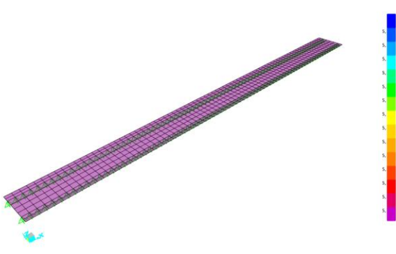
Figura 36. Representación de la carga originada por la sobrecarga de uso. (Fuente: SAP2000).
