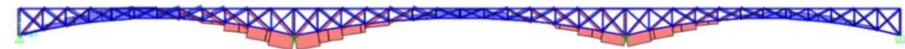
Figura 23. Valor del axil máximo en los arcos de la Solución 3.3. (Fuente: SAP2000).
