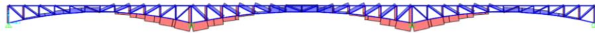
Figura 17. Valor del axil máximo en los arcos de la Solución 3.1. (Fuente: SAP2000).
