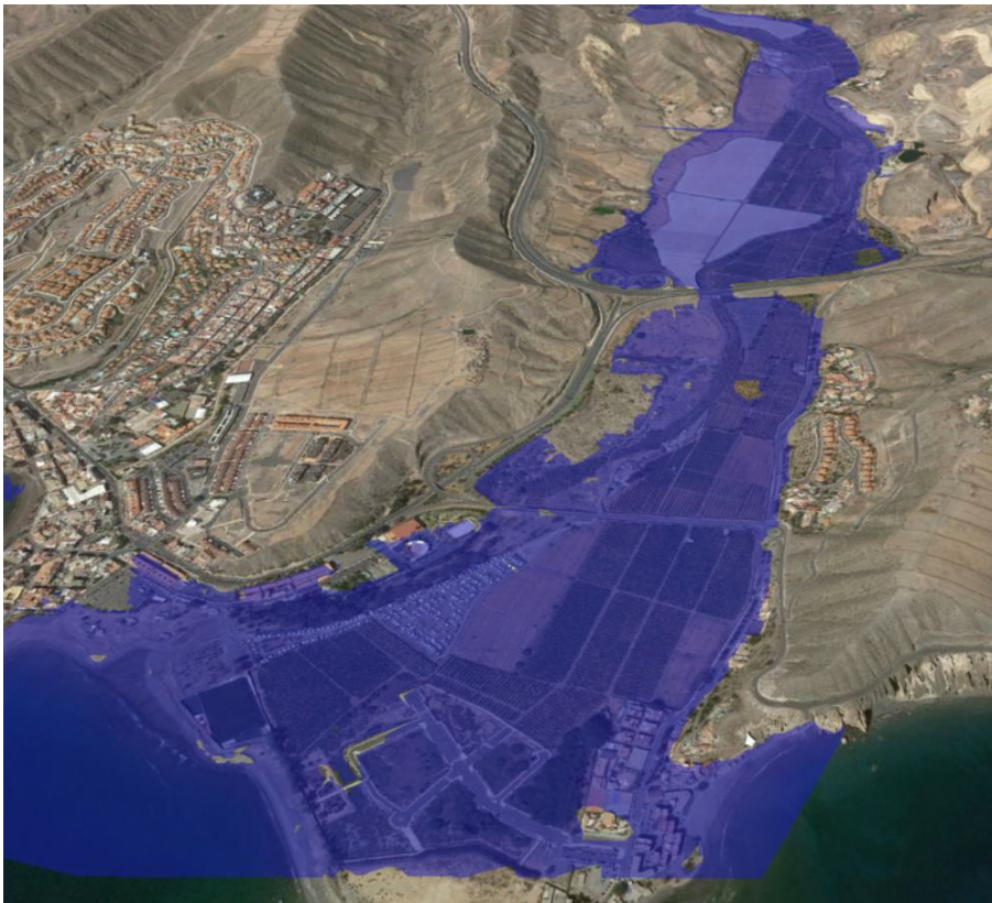
Figura 38. Inundación en Arguineguín, brecha en 10 minutos y con avenida.
