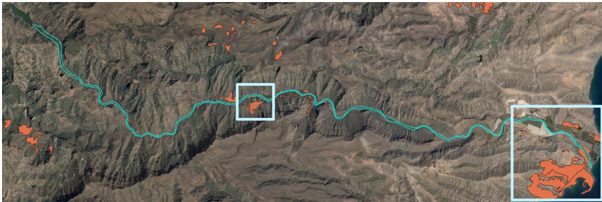
Figura 28. Referencia imágenes google earth, formación de brecha en 10 minutos y sin avenida.
