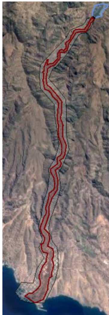
Figura 15. Malla de cálculo de HEC-RAS.
