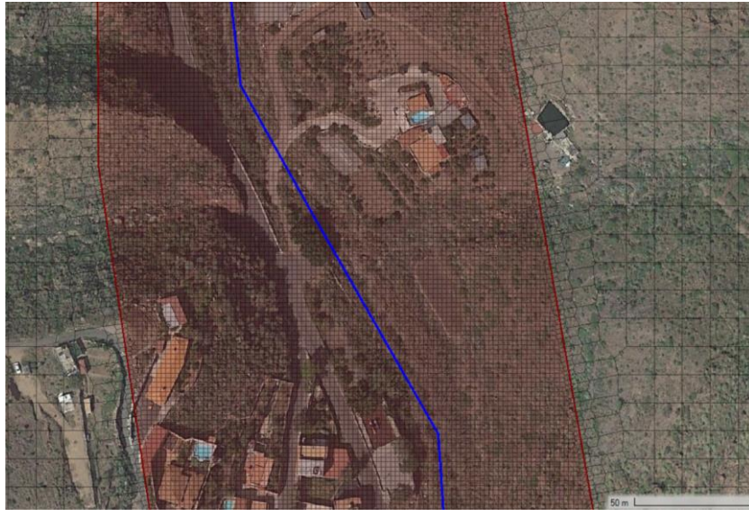
Figura 14. Detalle de la malla de cálculo del modelo.
