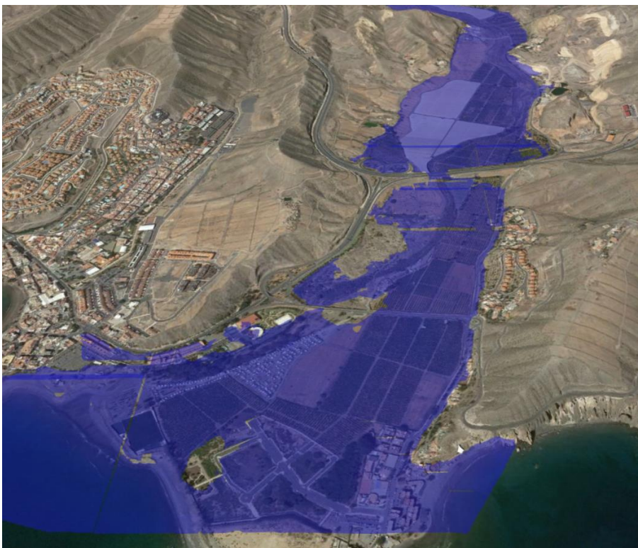
Figura 26. Inundación en Arguineguín, brecha en 15 minutos y sin avenida.
