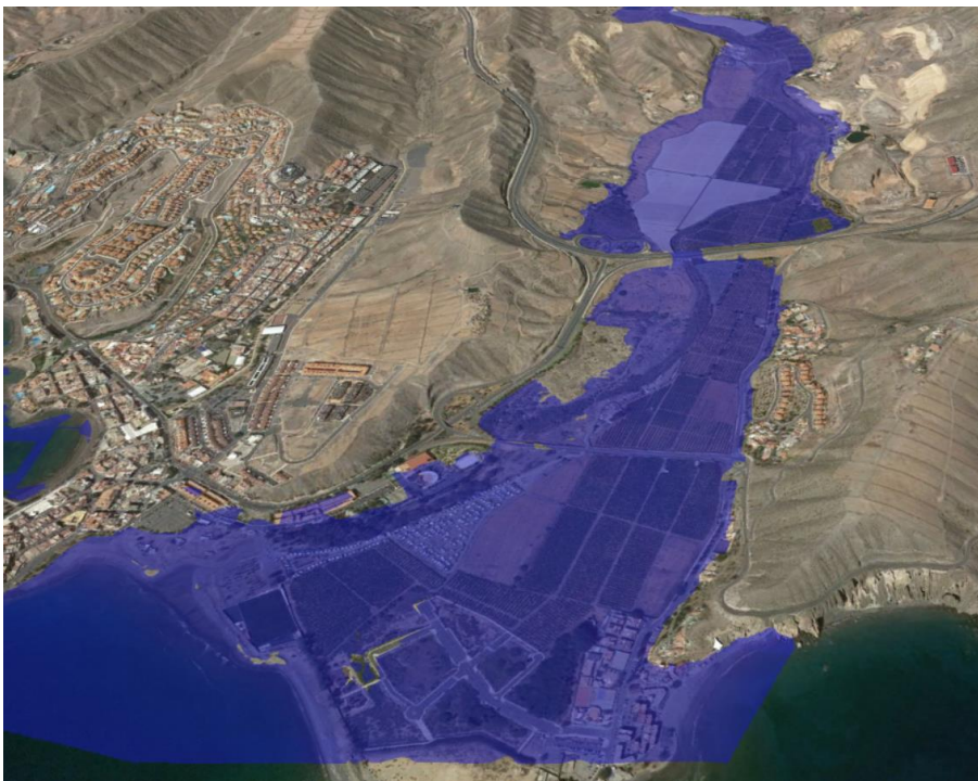
Figura 34. Inundación en Arguineguín, brecha en 15 minutos y con avenida.
