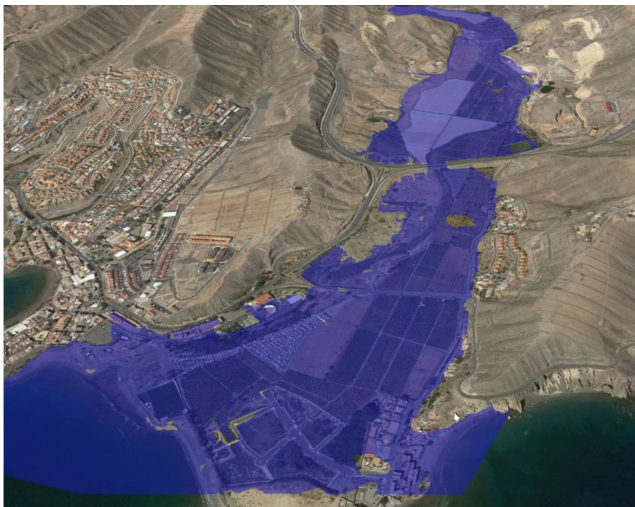
Figura 30. Inundación en Argineguín, brecha en 10 minutos y sin avenida.
