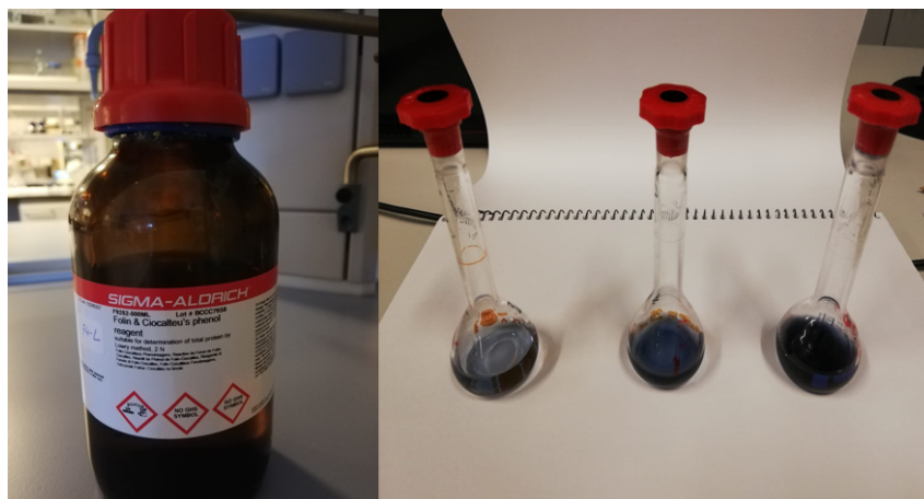
Figura 24: Reactivo de Folin-Ciocalteu y coloración de los compuestos fenólicos a diferentes concentraciones
