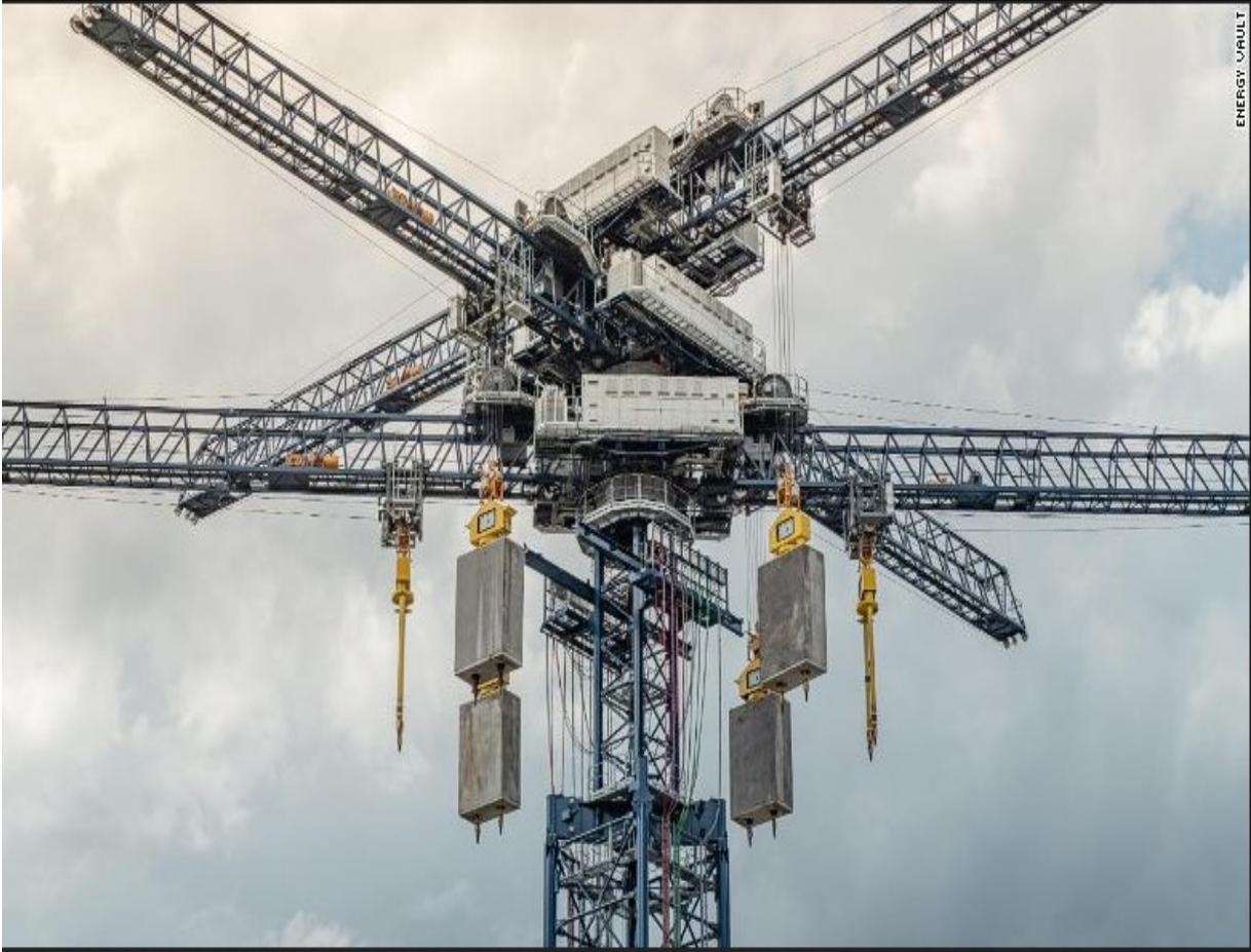
Figura 7.2: Imagen de la grúa utilizada para las baterías de hormigón
