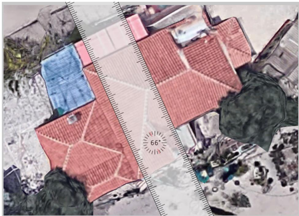
**Figura 3.5:** Plano satélite de la vivienda con ángulo azimut
