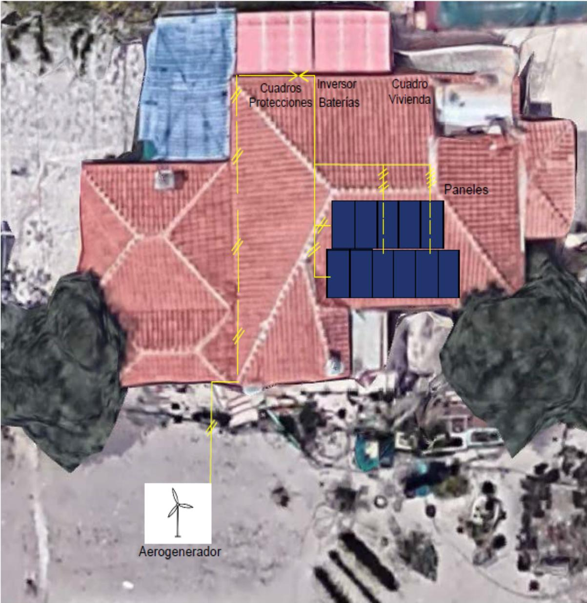
Figura 3.24: Plano 2D con la ubicación de los elementos del SHFE
