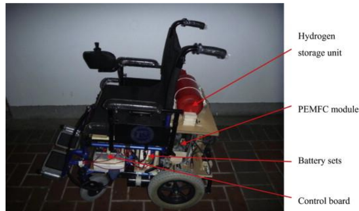
Figura 29 Silla de ruedas alimentada por PEMFC-batería (F. C. Wang & Chiang, 2012).
