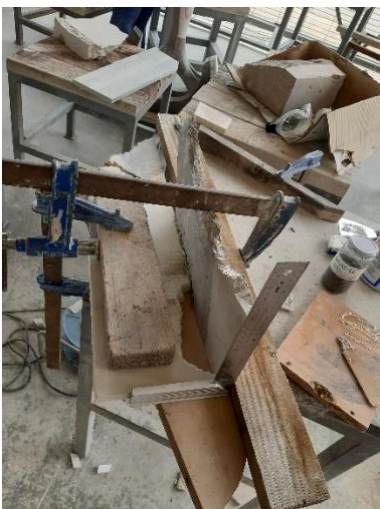
Figura 48: Encolado de dos piezas de mármol. Foto del autor.
