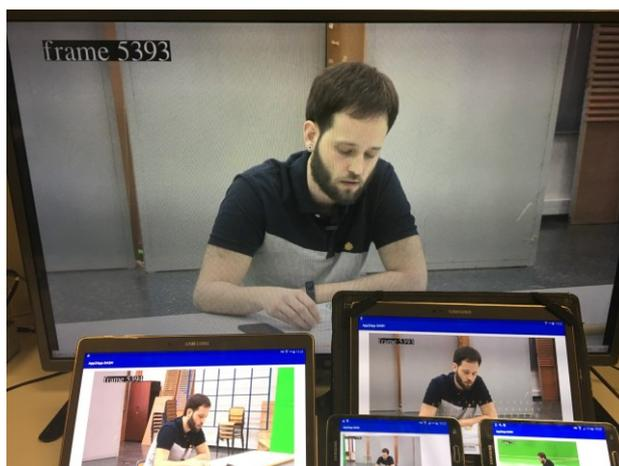
Fig. 74 Escenario IDES básico formado por un dispositivo principal (ejecutando la MS app) y 4 dispositivos secundarios (ejecutando la CS app)
