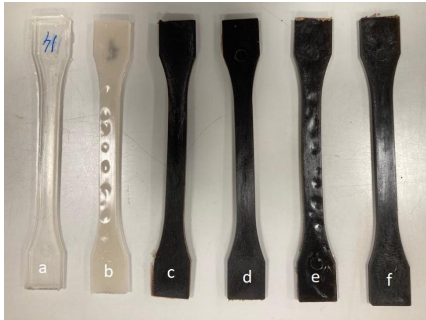
Fig. 51: Aspecto visual de las muestras a) PLA; b)PLA+20 \alpha -TA; c)PLA+20%MPF; d)PLA+10%MPF+22,5phr \alpha -TA; e) PLA+20%MPF+20 phr \alpha -T; f) PLA+30%MPF+17,5phr \alpha -TA
