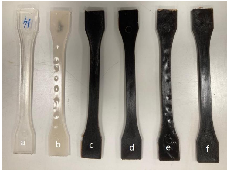
Fig. 22: Probetas de tracción (150x10x4 mm); a) PLA; b) PLA+20 a-TA; c) PLA+20%MPF; d) PLA+10%MPF+22,5phr a-TA; e) PLA+20%MPF+20 phr a-T; f) PLA+30%MPF+17,5phr a-TA
