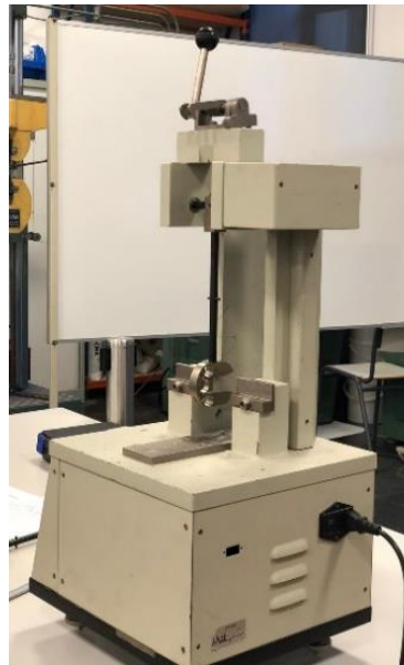
Fig. 25: Péndulo Charpy con célula de 1 J
