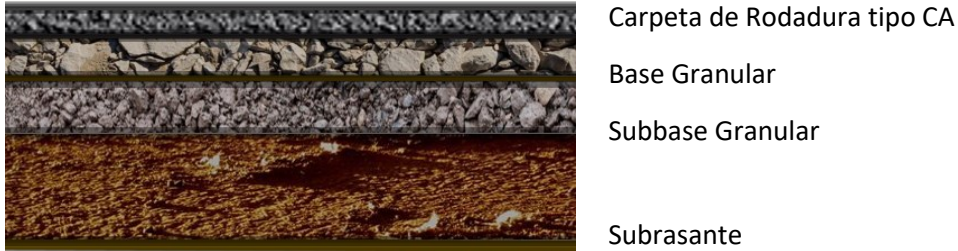
Figura 1 Estructura de Pavimento Flexible
