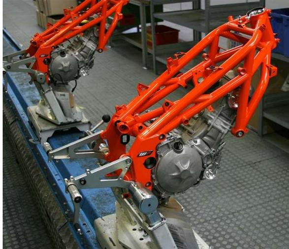
*Ilustración 41: Chasis multitubular de la marca KTM.*
