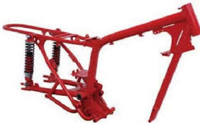
*Ilustración 14: Ejemplo de un chasis simple cuna abierto o interrumpido.*
