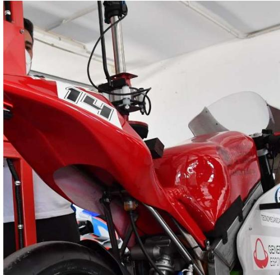
*Ilustración 62: Prueba estática de carga vertical con detalle del punto de aplicación de la carga.*
