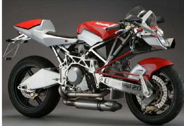
*Ilustración 22: Ejemplo de un chasis Omega.*
