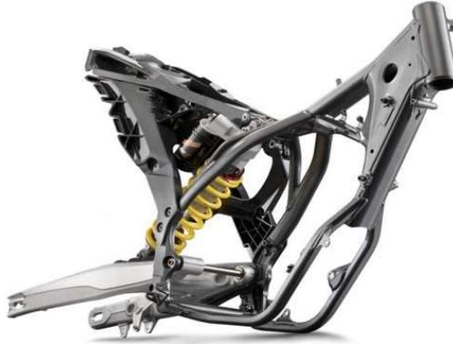
*Ilustración 15: Ejemplo de un chasis simple cuna desdoblado.*
