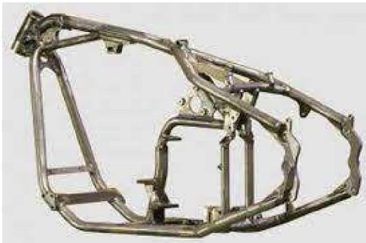
*Ilustración 16: Ejemplo de un chasis doble cuna.*
