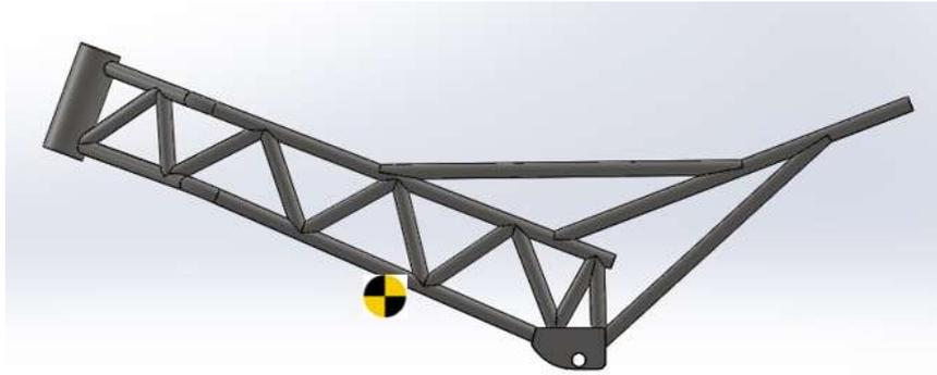
*Ilustración 79: Centro de gravedad del prototipo.*
