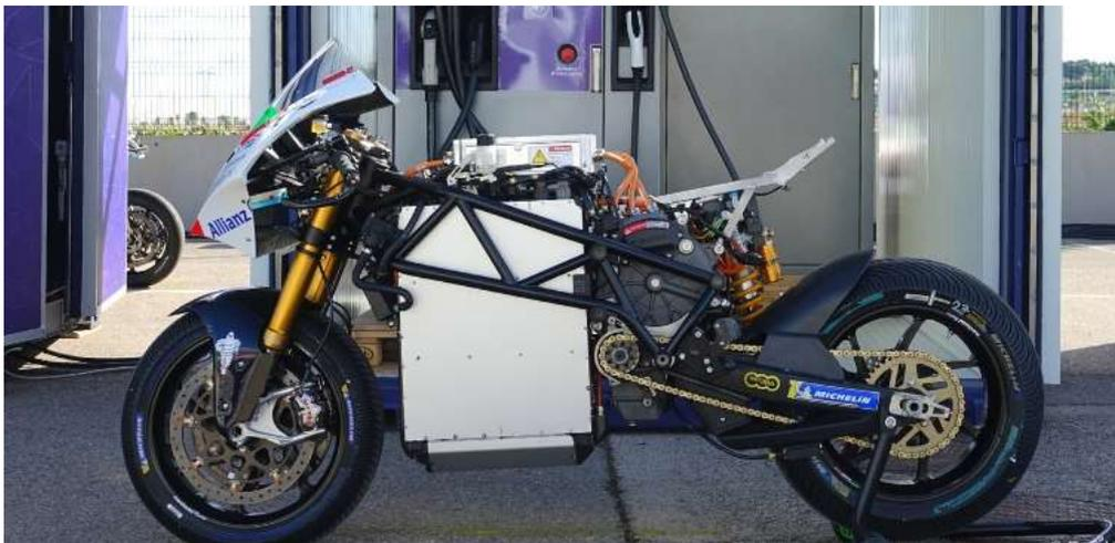
*Ilustración 43: Chasis multitubular empleado para la competición Moto-e.*
