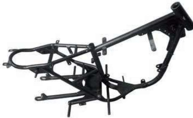
*Ilustración 13: Ejemplo de un chasis simple cuna cerrado.*
