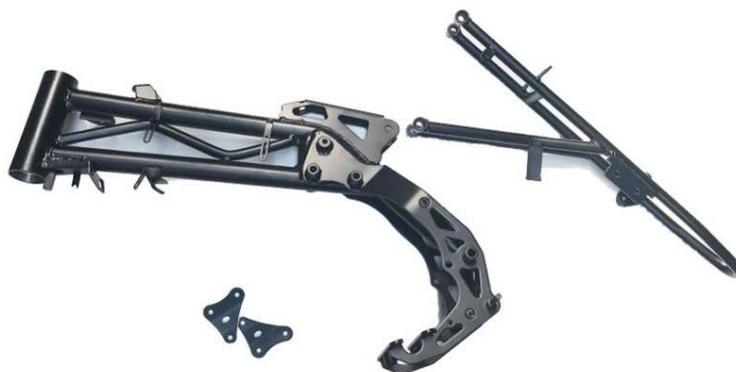
*Ilustración 20: Ejemplo de un chasis monoviga.*
