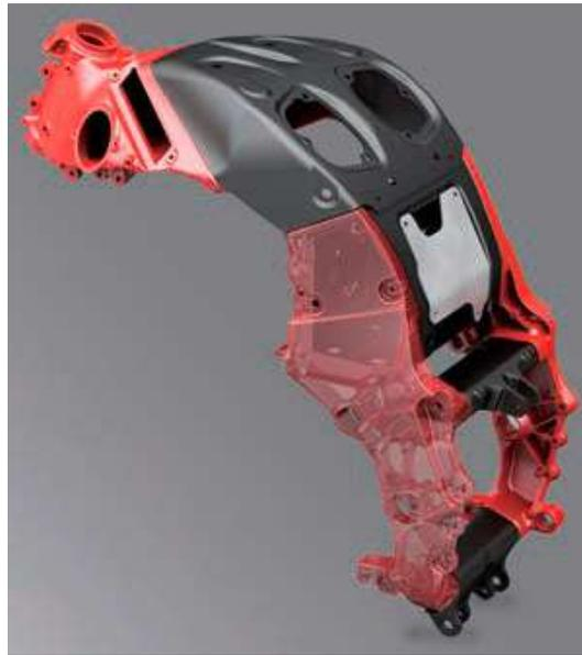
*Ilustración 21: Ejemplo de un chasis monocasco.*
