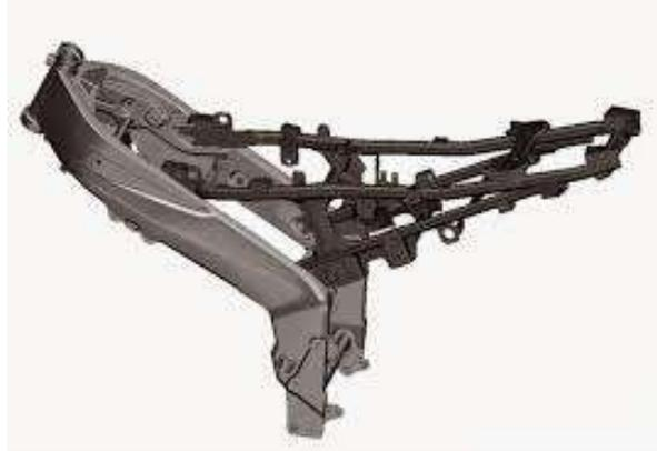
*Ilustración 18: Ejemplo de un chasis doble viga perimetral.*
