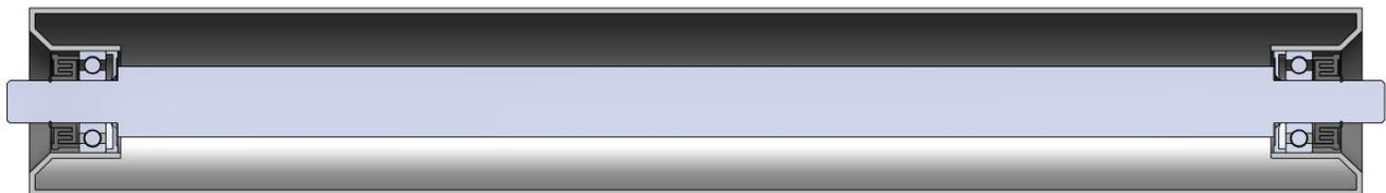
**Figura 35:** Sección del Conjunto Rodillo
