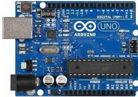
Figura 1. 38 Placa arduino UNO.(fuente: [www.store.arduino.cc](http://www.store.arduino.cc))
