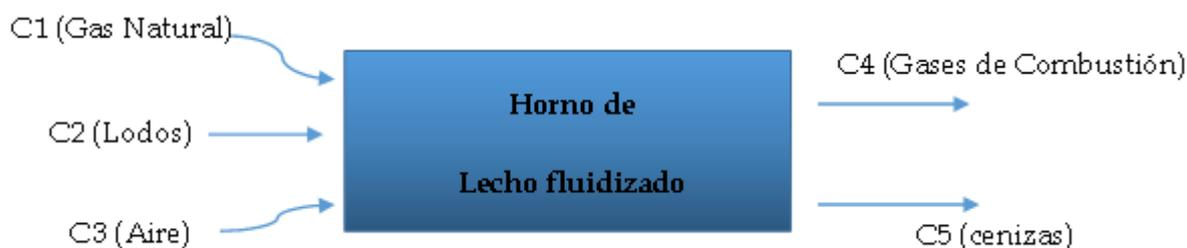
Figura 18. Esquema del horno incinerador y sus correspondientes entradas y salidas.
