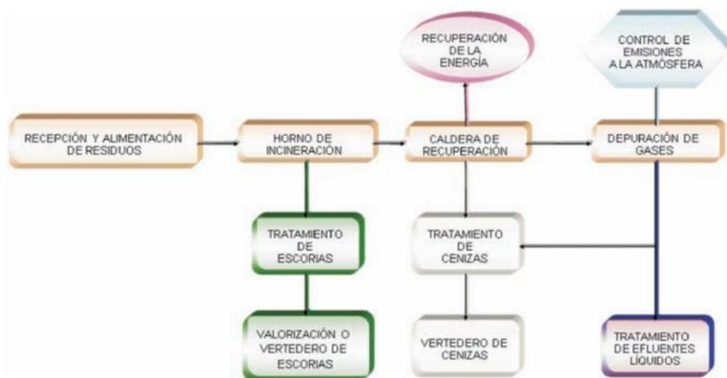
Figura 10. Diagrama de bloques de una instalación de incineración.
