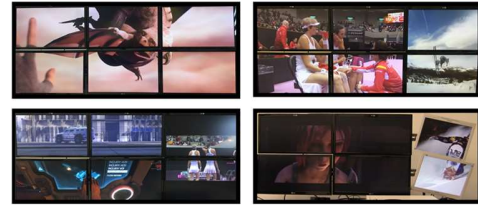
Fig. 6. Ejemplos de configuraciones de un sistema videowall 3x2.
