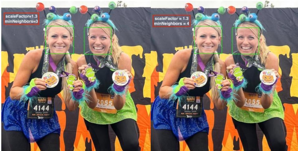
Figura 18 Resultado ejecución detector de caras con distintos minNeighbors
