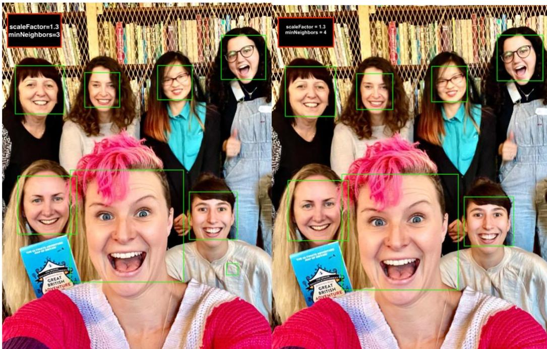
Figura 19 Resultado ejecución detector de caras con distintos minNeighbor
