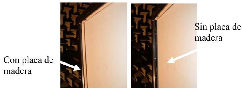
Figura 3.3.3.3.-Láminas de madera que permiten la sujeción o no a la placa
