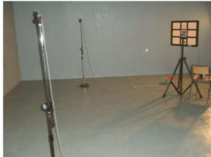
Figura 3.3.3.4: Montaje del altavoz y los micrófonos en cámara reverberante.
