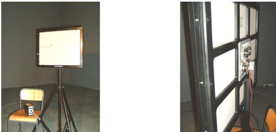
*Figura 3.3.4.1. Cara anterior y posterior de la superficie estudiada montada en el marco*
