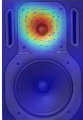
fig. 3.1.1.1. Caja acústica radiando a 4 kHz
