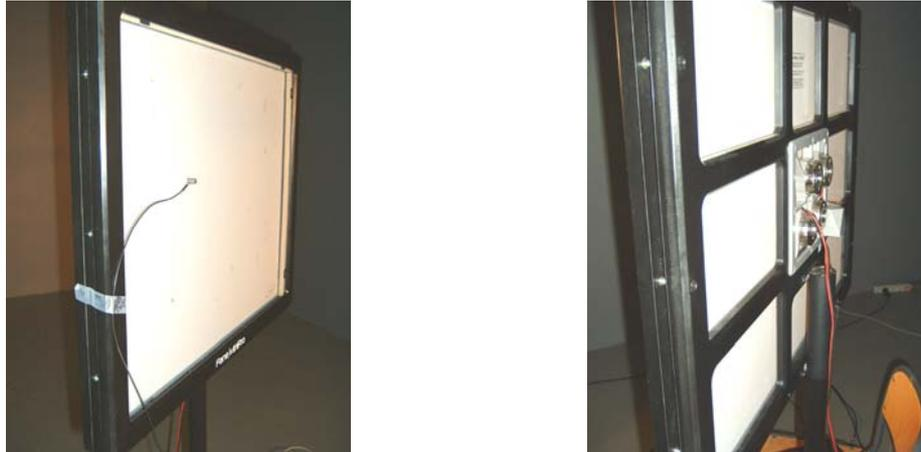
*Figura 1.1. Cara anterior y posterior del altavoz DML montado en marco.*
