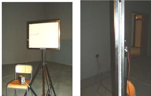
Figura 3.3.2.1. Altavoz plano DML en cámara reverberante
