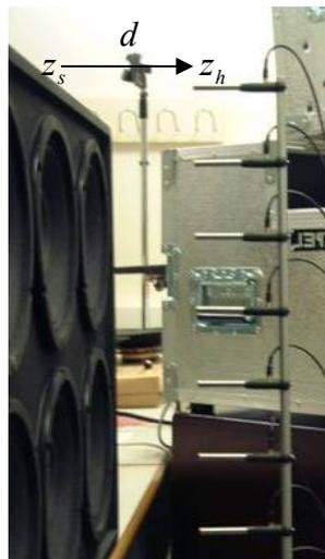
Figura 3.1.1. Plano fuente  $z_s$  y plano del holograma  $z_h$
