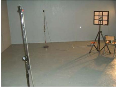
Figura 3.3.4.2. Superficie montada en marco ubicada en cámara reverberante para medir.
