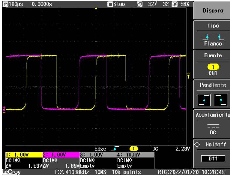
Figura 19 Oscilograma de las señales A y B girando en sentido horario (elaboración propia)
