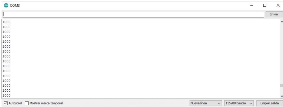
Figura 43 Captura de la salida por puerto serie de la aplicación Arduino IDE indicando los pulsos contados por revolución (elaboración propia)
