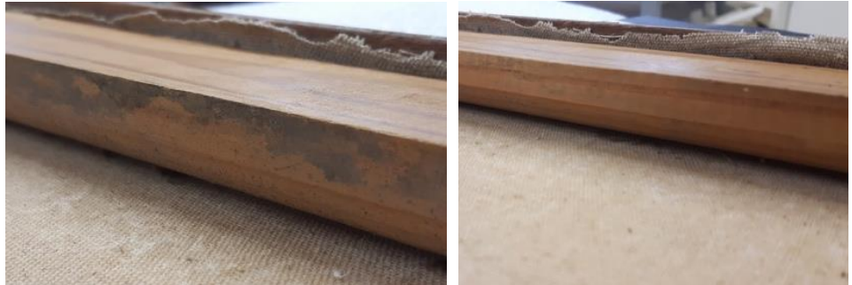
Figura 31 (a,b): Comparación del bastidor antes (izquierda) y después (derecha) de la limpieza con una solución hidroalcohólica.
