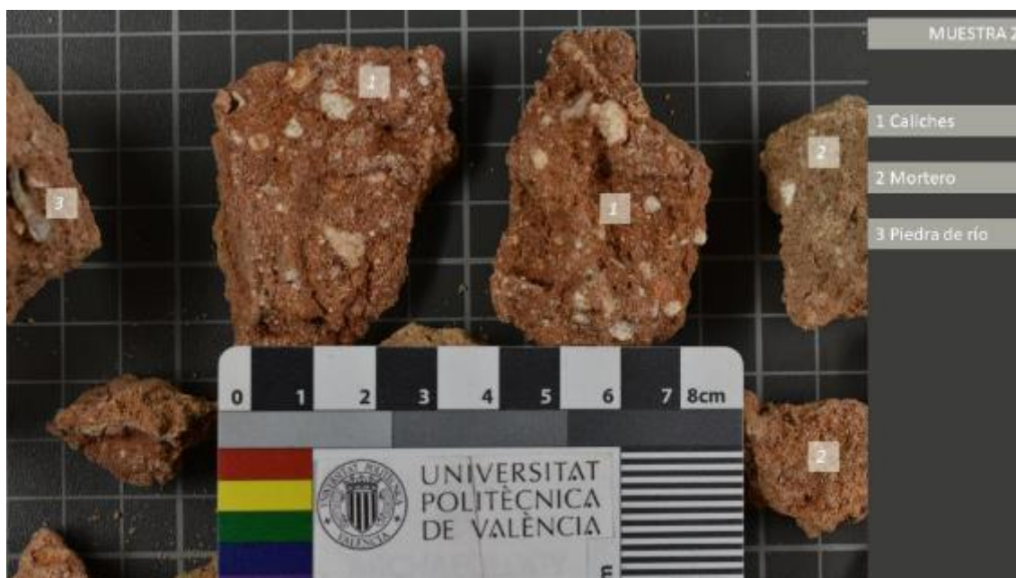
Muestra 2. Imagen informativa de los elementos presentes en el mortero. Se aprecia, en menor medida, la utilización de piedras de árido de \pm 0,5 cm como árido de particulado mayor. Fuente: CASTELLET, 2021.
