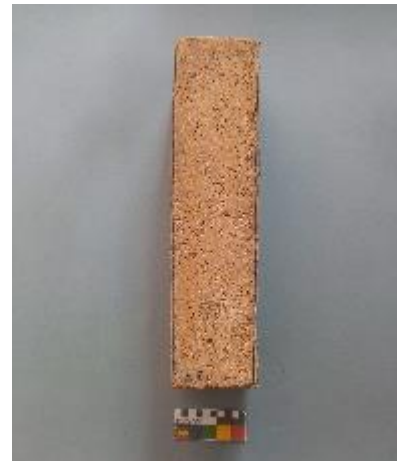
Figura. 56. Probeta Mortero A con polímero. Después del ciclo hielo-deshielo. No se aprecia cambio. Fuente: CASTELLET, 2022.
