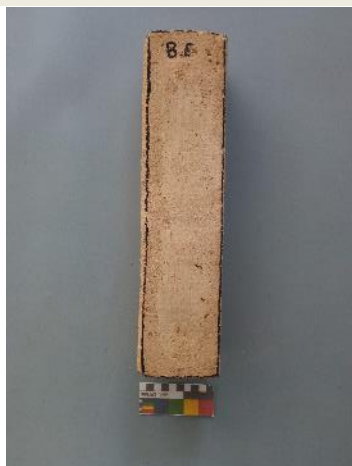
Probeta con polímero antes de ciclo de hielo-deshielo. Fuente: CASTELLET, 2022.
