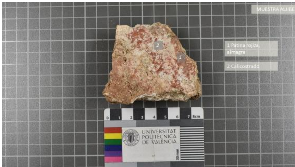
Muestra Aljibe. Fotografía general del anverso. Restos de pátina de color almagra y enlucido calicostrado de alta concentración de cal. Fuente: CASTELLET, 2021.
