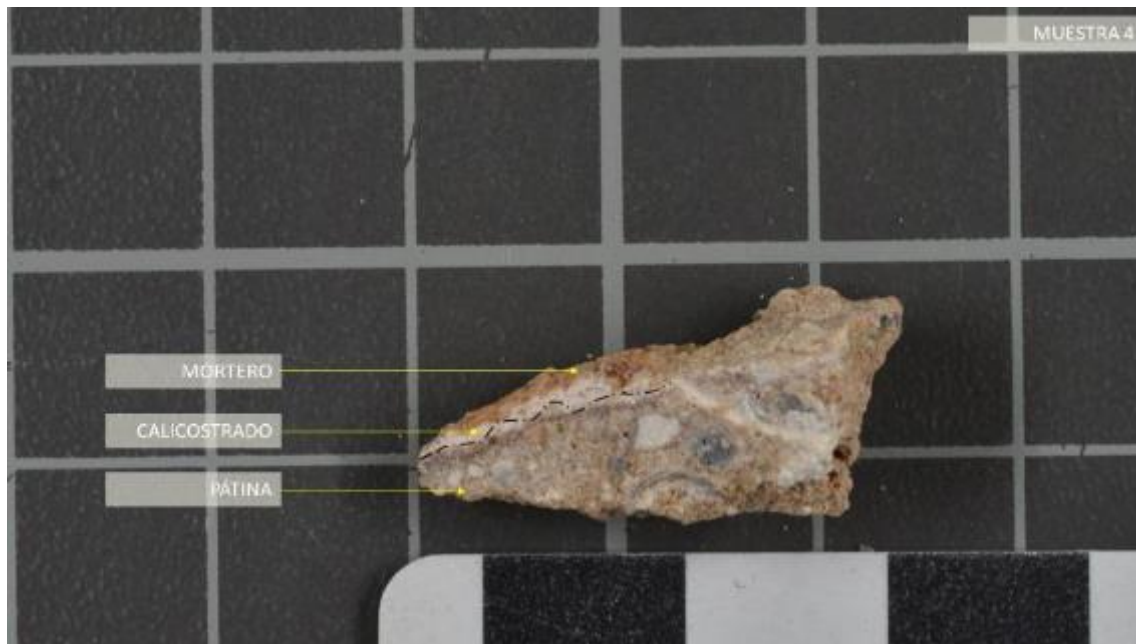
Muestra 4. Fragmento descriptivo de las partes del mortero. Pátina de tonalidad blanquecina en la que se observan áridos de composición calcárea (sedimentaria) y silícea (cuarzo) Fuente: CASTELLET, 2021.
