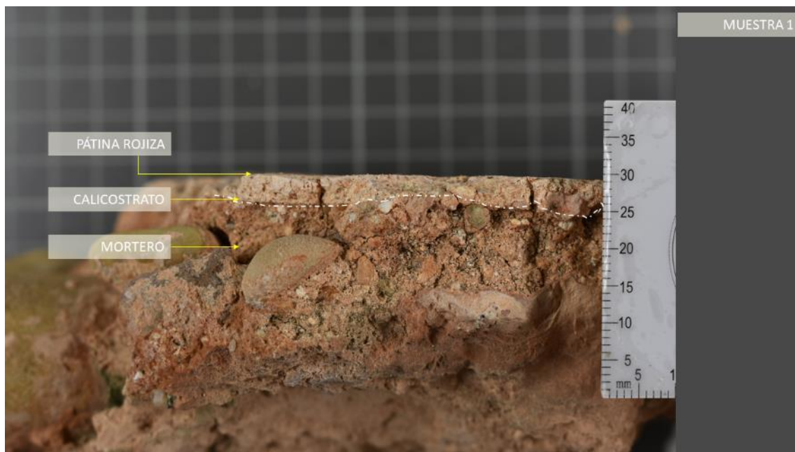
Figura. 40. M-1. Mortero del paramento Norte interior. Se aprecian los clastos muy cerca de la superficie. Diversidad en cuanto a áridos y tamaño. Tono rojizo. Fuente: CASTELLET, 2021.
