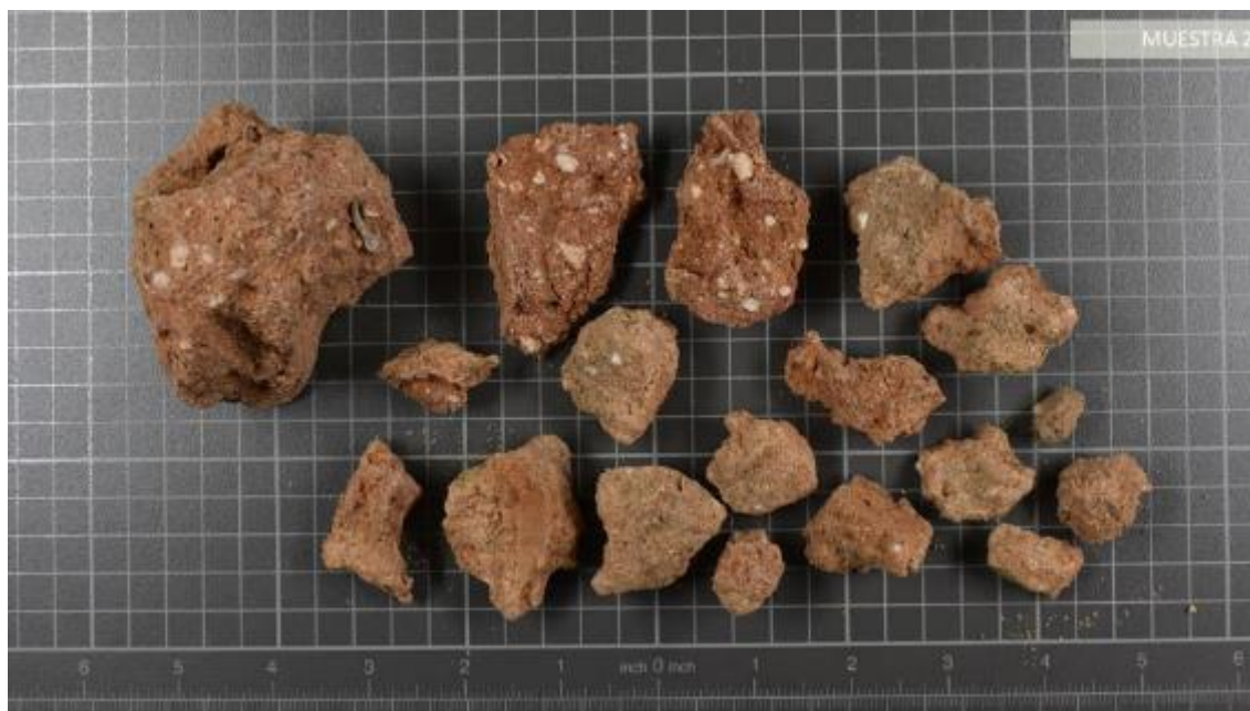
Muestra 2. Imagen general del total de la muestra de mortero. Los fragmentos de tamaño superior presentan más óxidos de cal (CaO) respecto a los fragmentos de tamaño inferior. Fuente: CASTELLET, 2021.
