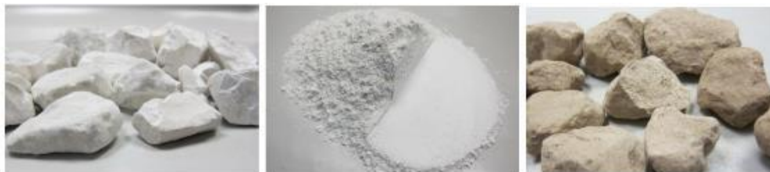
Figura. 27. Tipología de las cales. De izqda. a dcha.: Cal viva, cal hidratada, cal dolomítica calcinada. Fuente: USEDO, 2015.
