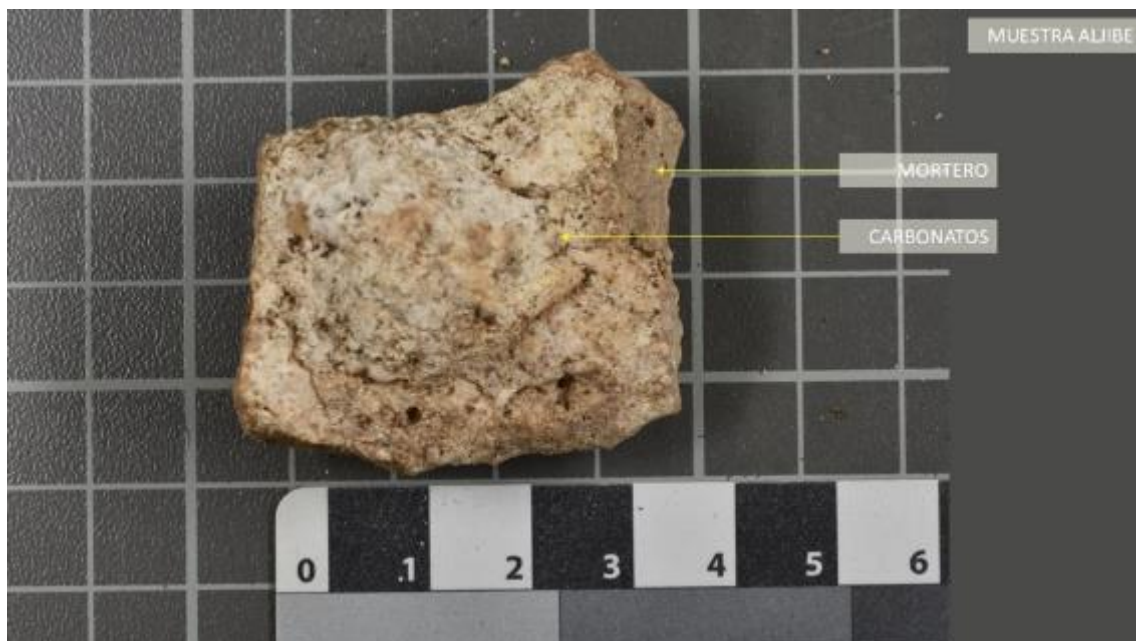
Muestra Aljibe. Fotografía general del reverso. Mortero de con alta dosificación de cal (calidades más impermeables de mejor idoneidad en estructura donde se almacena agua). Fuente: CASTELLET, 2021.
