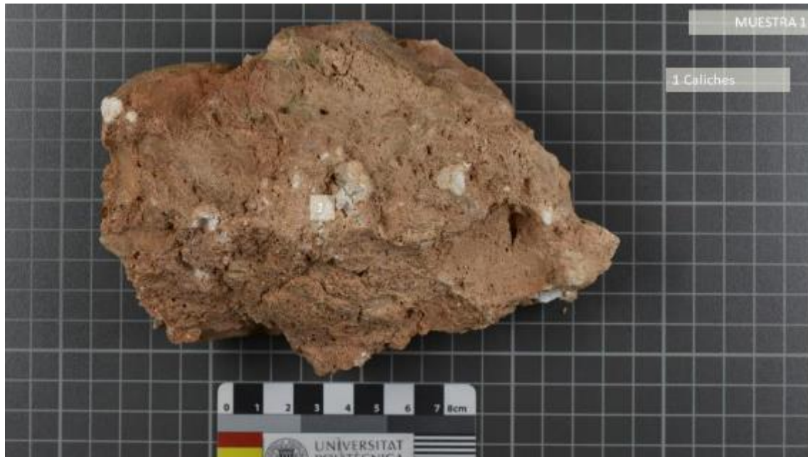
Muestra 1. Reverso del mortero en el que se observan varios restos de óxido de cal (CaO) de hasta 1,5 cm. Fuente: Castellet, 2021.
