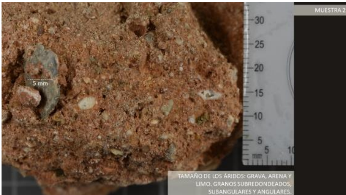
Muestra 2. Imagen macro de uno de los fragmentos. Se puede observar la diferencia entre los áridos utilizados en cuanto al tamaño y material (piedras calizas, cuarzo, arcillas). Fuente: CASTELLET, 2021.
