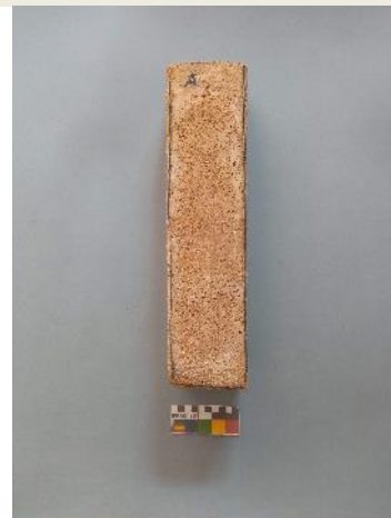
Probeta sin polímero después de ciclo hielo-deshielo. La rotura y disgregado del material se produjo tras el primer ciclo. Fuente: CASTELLET, 2022.
