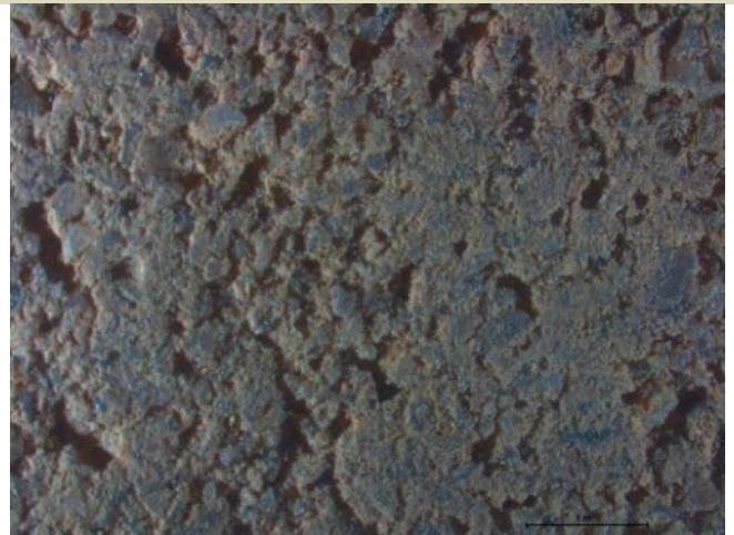
Imagen a lupa binocular LEICA. Escala: 1mm. Se aprecia la disposición de los áridos de polvo de mármol de 200 μm y arena de sílice de 0,2μm.
