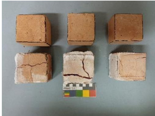
Figura. 53. Mortero A. Sup.: morteros testigos; Inf.: morteros a ensayo. De izqda. a drcha.: mortero natural (sin EVA ART), mortero natural (sin EVA ART) y mortero con EVA ART. Se observa como la probeta con polímero no ha sufrido rotura interna y una menor proliferación de sales. Fuente: CASTELLET, 2022.
