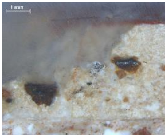
Figura. 46. Análisis por Mo de la Muestra del aljibe. Contiene partículas de color negro con presencia de óxido alrededor de las mismas. En zona sup. drcha., se aprecia la pátina de almagra de la zona de superficie. Fuente: CASTELLET, 2022.
