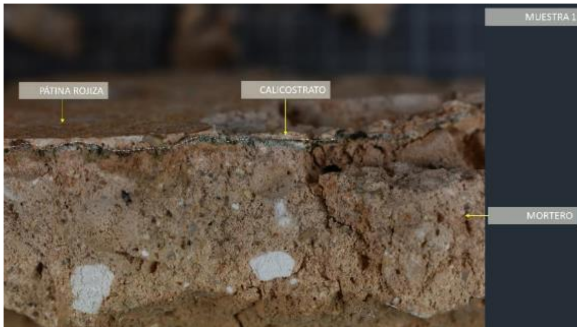
Muestra 1. Detalle de los elementos presentes en la muestra (de arriba abajo): Pátina rojiza, calicostrado, mortero con caliches y microcaliches. Fuente: CASTELLET, 2021.
