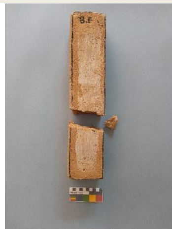
Probeta con polímero después de ciclo hielo-deshielo. La rotura y disgregado del material se produjo tras el segundo ciclo. Fuente: CASTELLET, 2022.
