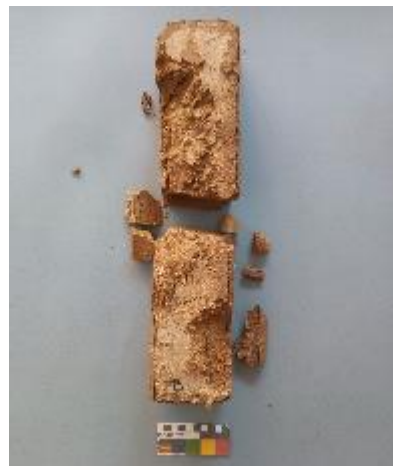
Figura. 58. Mortero C con polímero después de ciclo hielo-deshielo. La rotura y disgregado del material se produjo tras el primer ciclo. Fuente: CASTELLET, 2022.
