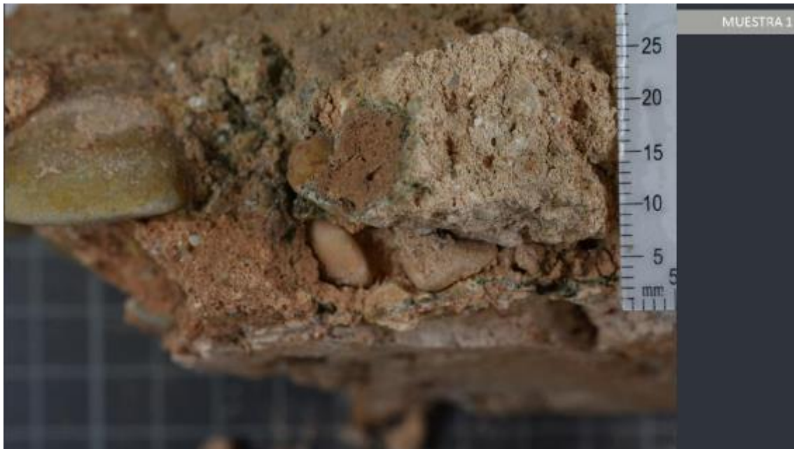
Muestra 1. Imagen transversal del mortero. Se puede observar como para la ejecución de la base del mortero, se utilizaron diversidad de partículas de árido, así como arcillas, limo, arena, grava y clastos. Fuente: CASTELLET, 2021.
