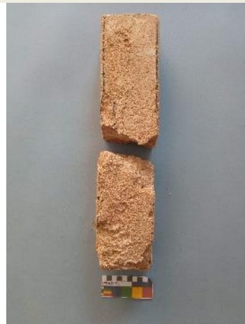
Probeta con polímero después de ciclo hielo-deshielo. La rotura y disgregado del material se produjo tras el tercer ciclo. Fuente: CASTELLET, 2022.
