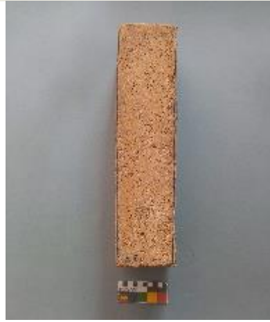
Probeta con polímero. Antes del ciclo hielo-deshielo. Fuente: CASTELLET, 2022.
