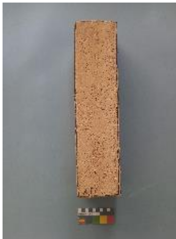
Figura. 55. Probeta Mortero A con polímero. Antes del ciclo hielo-deshielo. Fuente: CASTELLET, 2022.
