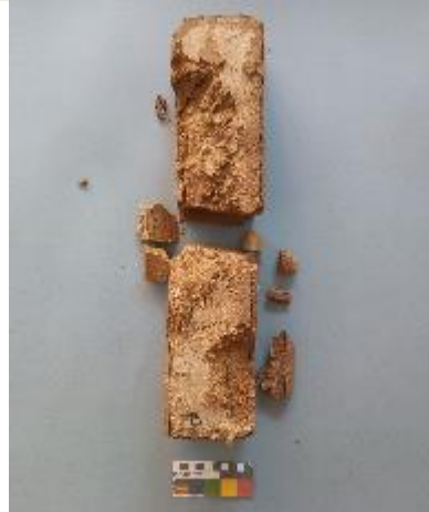
Probeta con polímero después de ciclo hielo-deshielo. La rotura y disgregado del material se produjo tras el segundo ciclo. Fuente: CASTELLET, 2022.
