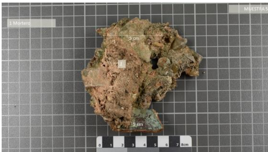
Muestra 5. Imagen general del mortero. Reverso. Presencia de áridos arcillosos, así como de clastos de dimensiones de hasta 5 cm y fragmentos cerámicos. Fuente: CASTELLET, 2021.
