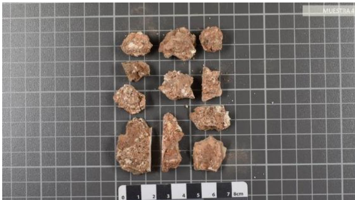
Muestra 4. Reverso. Imagen general de la muestra fragmentada. Se aprecia la presencia de caliches en la mayoría de los guarnecidos. Fuente: CASTELLET, 2021.
