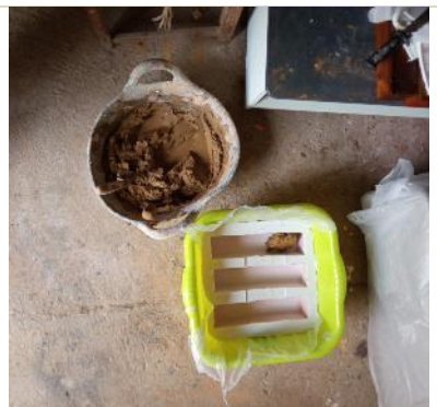
Aplicación del mortero en molde de silicona. Fuente: CASTELLET, 2022.
