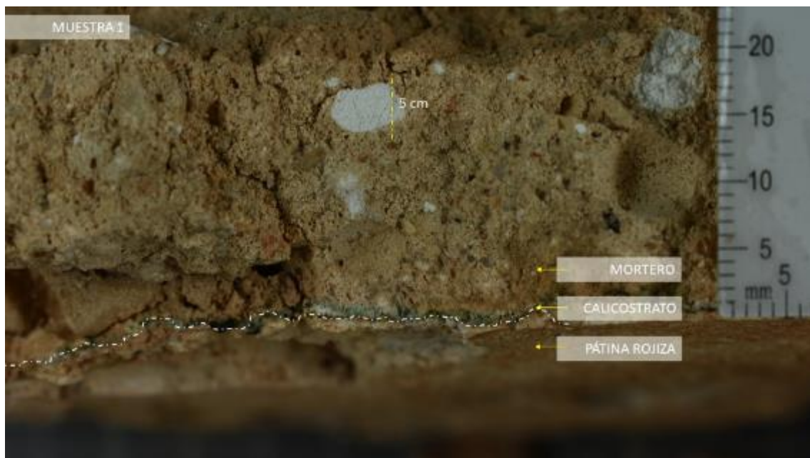
Muestra 1. Detalle de los elementos presentes en la muestra. Mortero con espesor de 2,5 cm en el cual encontramos caliches de 0,5 cm, pero también microcaliches como se aprecian en la imagen. Respecto al calicostrato, se percibe un sutil y ligero sobre el cual se ha aplicado la pátina rojiza Fuente: CASTELLET, 2021.
