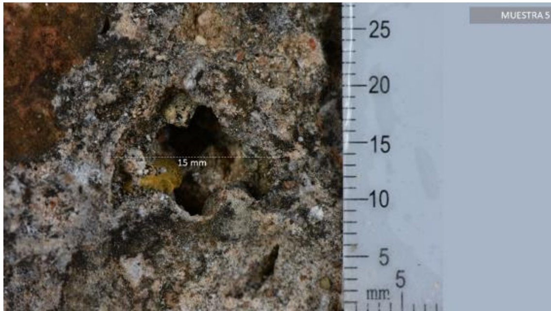
Muestra 5. Fotografía macro del anverso. Imagen representativa de los orificios de 1,5 cm de diámetro presentes en la superficie del mortero. También se observa la presencia de líquenes, y hongos, así como grava (árido de cuarzo). Fuente: CASTELLET, 2021.
