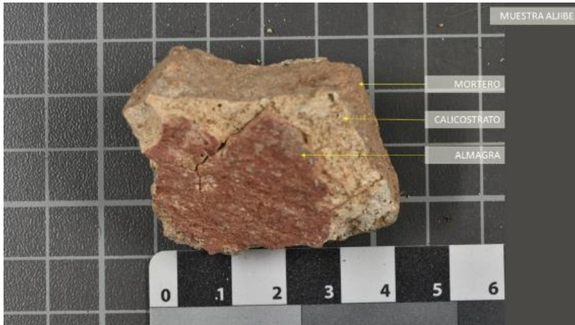
Muestra Aljibe. Fotografía general del anverso. Pátina de color rojo almagra, seguida de calicostrato y mortero con fuerte presencia de cal. Fuente: CASTELLET, 2021.
