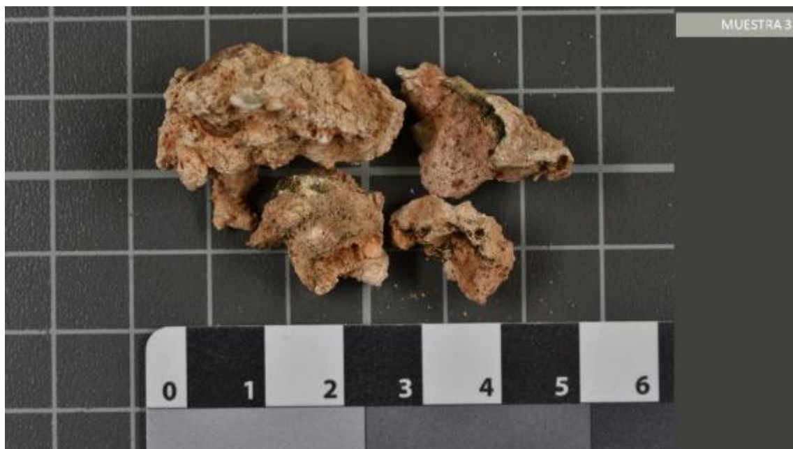
Muestra 3. Imagen general de la muestra. Se pueden observar los áridos dispuestos entre los fragmentos de enlucido, al igual que la presencia de microorganismos. Fuente: CASTELLET, 2021.
