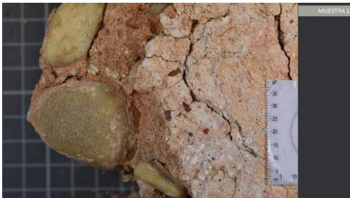
Muestra 1. Anverso. Imagen representativa de la diversidad de áridos presentes en la muestra. En superficie se aprecian tanto microcaliches como áridos de partículas pequeñas y coccio pesto . En Mortero, se hayan clastos de río de dimensiones considerables. Fuente: CASTELLET, 2021.
