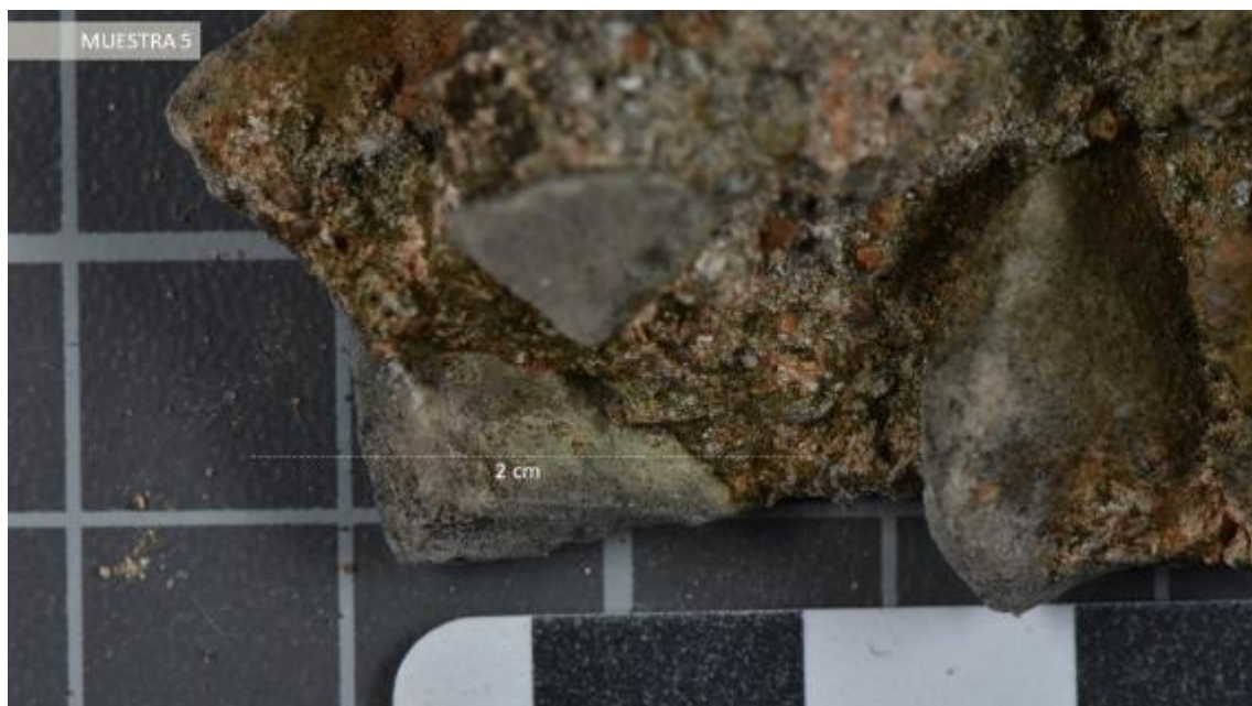
Muestra 5. Fotografía macro del reverso del mortero. Presencia de clastos de río de \pm 2 cm de diámetro, así como grava de diversa granulometría y coccio pesto . Fuente: CASTELLET, 2021.
