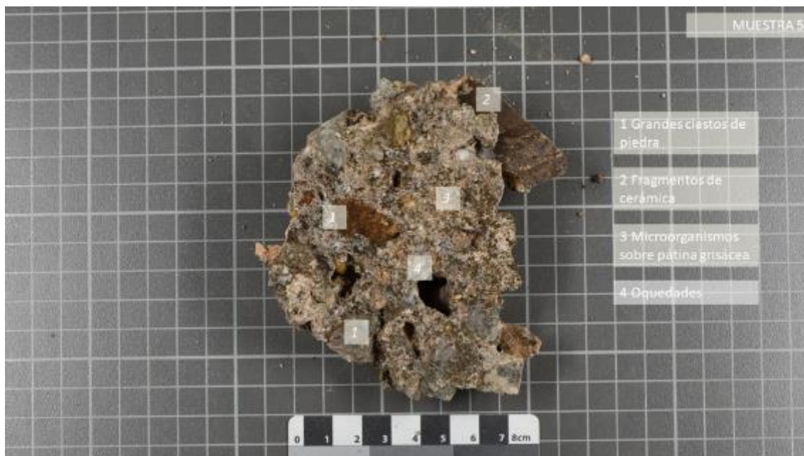
Muestra 5. Imagen general del mortero. Anverso. Se observa la diversidad de áridos en enlucido y guarnecido, además de agujeros de tamaños considerables y la presencia de microorganismos repartida por toda la superficie. Fuente: CASTELLET, 2021.
