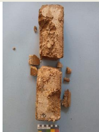
Probeta sin polímero después de ciclo hielo-deshielo. La rotura y disgregado del material se produjo tras el tercer ciclo. Fuente: CASTELLET, 2022.
