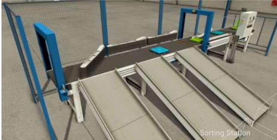
Figura 46 .- Cinta de clasificación de paquetería y equipajes II
