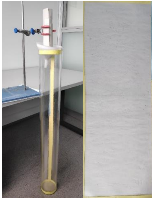
Figura 44. La fotografía de la izquierda muestra el sistema empleado para lanzar las moscas y la derecha como quedan pegadas al plástico para su posterior cuantificación
