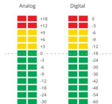
Figura 16. Vímetro: En el caso de los vímetros, el color que se visualiza denota el nivel de la señal de entrada, lo que permite controlar sus ajustes.
