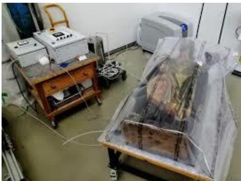
**Imagen 21** . Ejemplo de sistema de desinsectación por atmósfera modificada.
