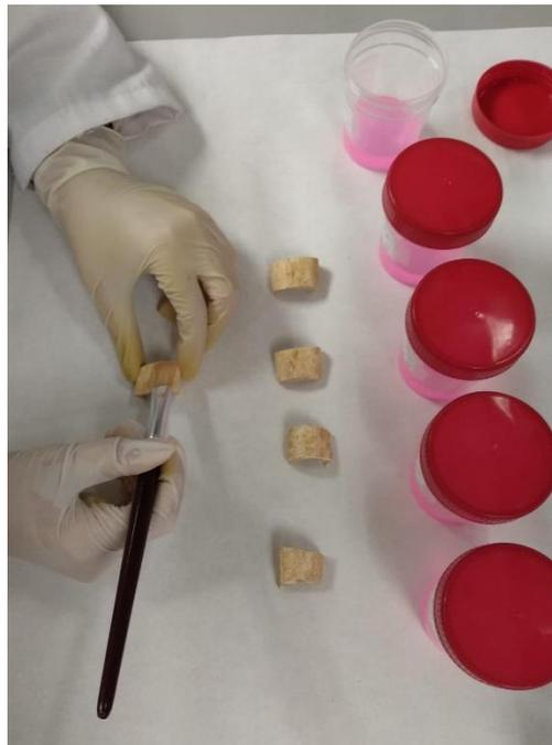
Figura 21. Consolidación de probetas (Serie A).
