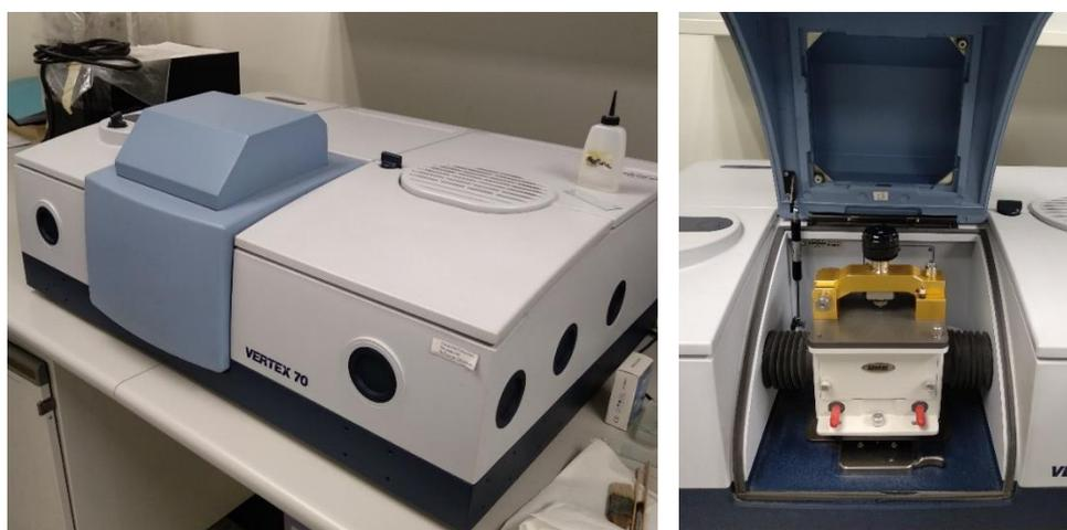
Figuras. 32 y 33. Equipo ATR-FTIR Vertex 70 del IRP, Universidad Politécnica de Valencia.
