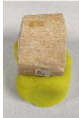
Figura 65. Ensayo de absorción de la gota de la probeta P0.
