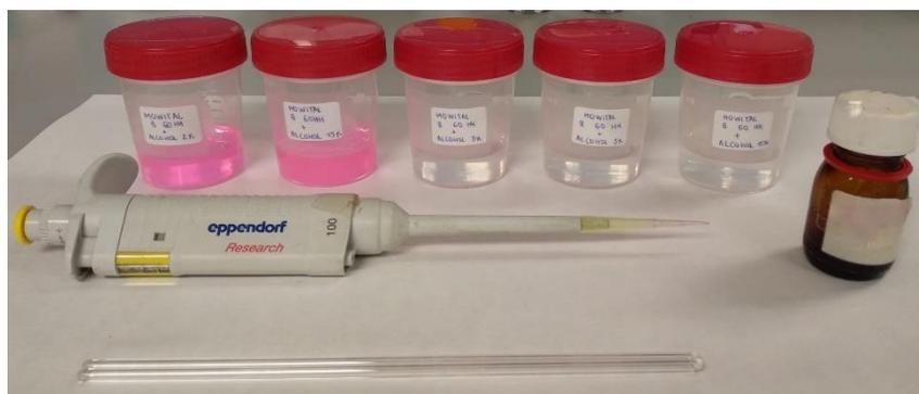
Figura 15. Material empleado para la adición del colorante Rodamina B en proceso de preparación.
