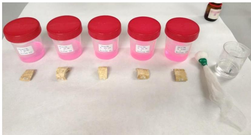
Figura 22. Impregnación de las probetas con etanol con la ayuda de una muñequilla.
