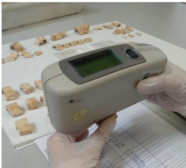
Figura 28. Evaluación fotométrica. Toma de mediciones con brillómetro Multi Gloss 268.
