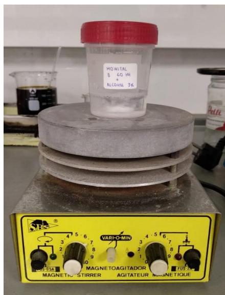
Figura. 14. Agitador magnético empleado para la preparación de las disoluciones.
