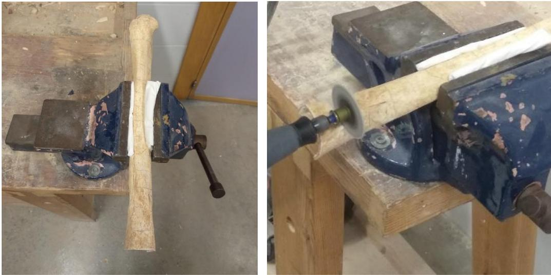
Figuras. 9-10. Proceso de sección de probetas empleando la herramienta DREMEL® 4000.
