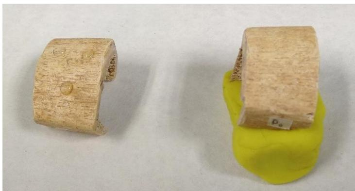
Figura 31. Ensayo de absorción de la gota. Probetas A3 y P0.
