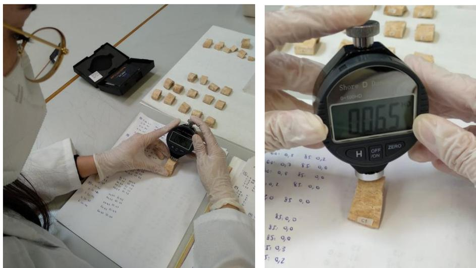
Figuras 29-30. Adquisición de las medidas de dureza.
