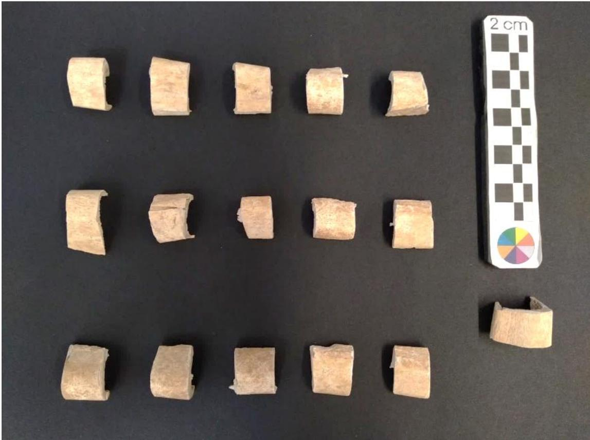
Figura 13. Aspecto final de las probetas tras el proceso de limpieza.
