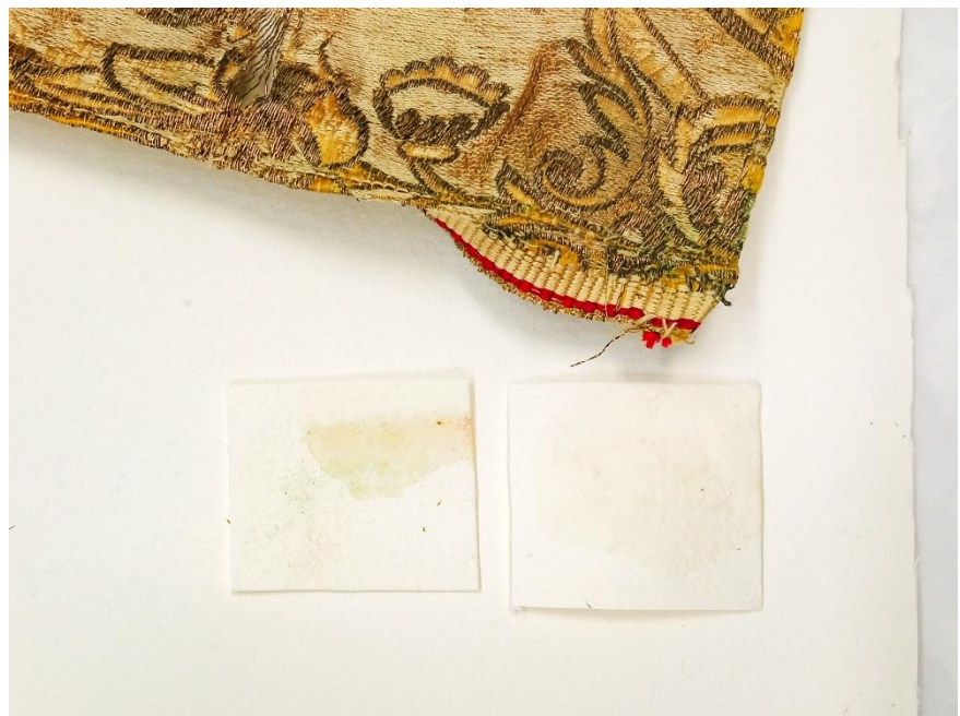
Fig. 33. Fotografía del resultado en la prueba de solidez de los tintes realizada en el orillo del tejido labrado. Fotografía detalle; Nikon D5200.
