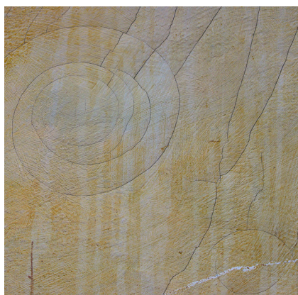
Figura 48.- Fotografía con microscopio digital Dino.Lite® a 55x. Craqueladura
