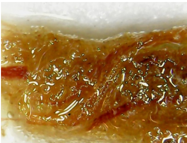
Fig. 18 Ensayo de floroglucina
