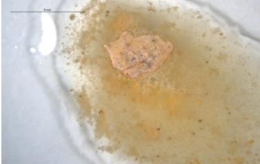
Fig. 27 Ensayo de ioduro potásico, gota de ácido carbónico
