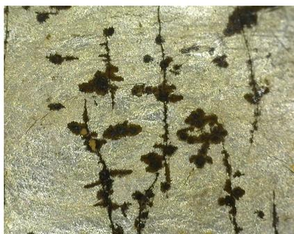
**Imagen 72.-** Sulfuración de la plata que "brota" por las craqueladuras.
