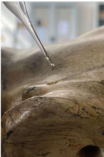
**Imagen 105.-** Colocación de la gota sobre la superficie mediante una pipeta.
