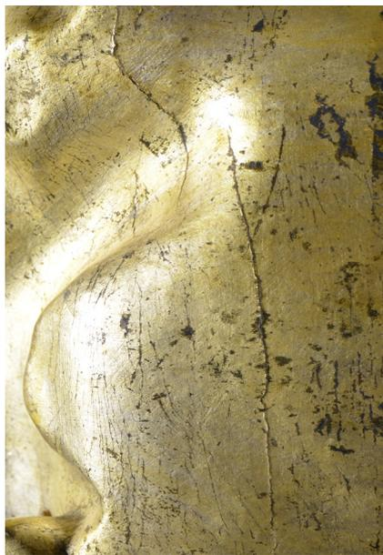
**Imagen 74.-** Grietas verticales que siguen la veta radial vertical de la madera.
