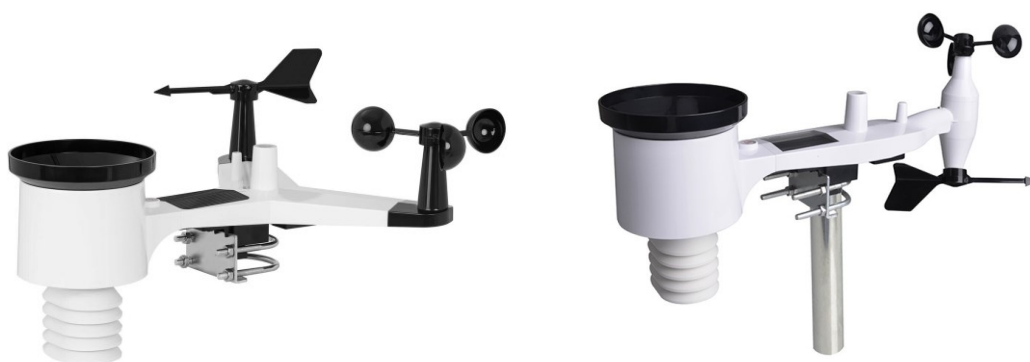
Fig. 11: Bloques de sensores integrados WH65 (izqda.) y WH69 (dcha.)
