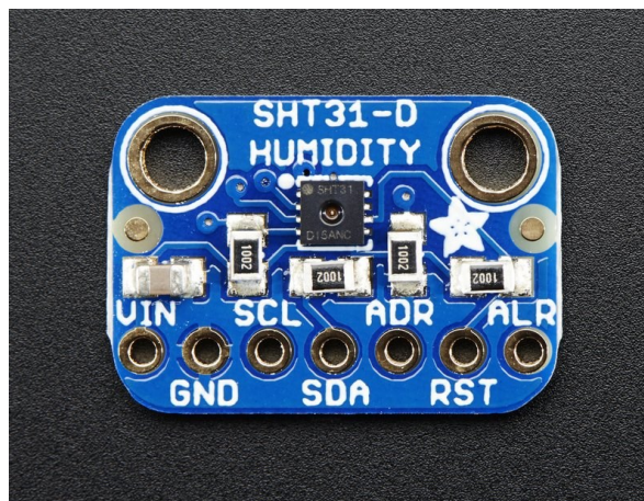
Fig. 5: SHT31 en Breakout Board de Adafruit®
