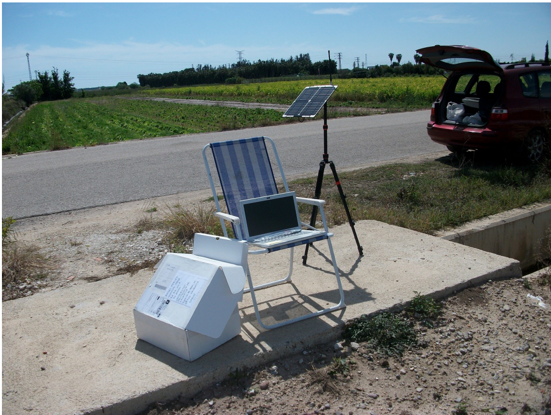
Fig. 60: Primer intento de transmisión con un valor de RSSI de -95 dBm.
