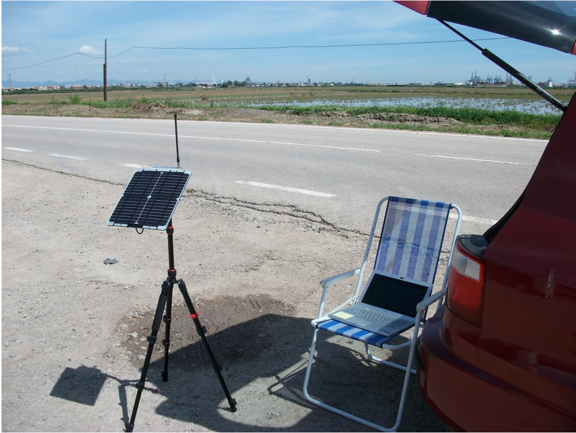
Fig. 61: Segundo intento de transmisión con un valor de RSSI de -100 dBm.
