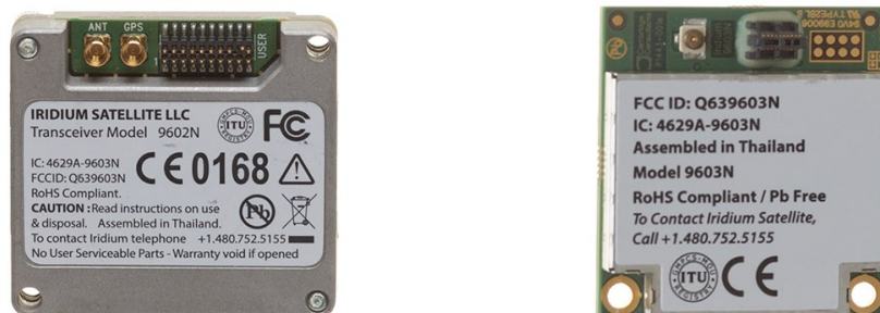
Fig. 31: Módulos 9602 (izqda.) y 9603 (dcha.)
