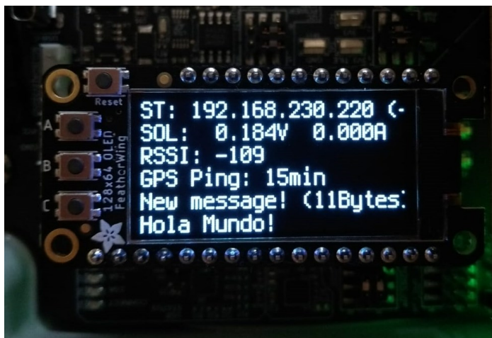
Fig. 56: Pantalla OLED del FeatherS2 configurado como cliente MQTT
