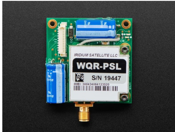
Fig. 32: Módem Rock7 RockBLOCK 9603 ( www.adafruit.com )
