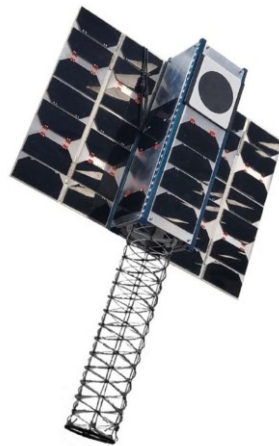
Fig. 29: Satélite CubeSat 3U con antena helicoidal
