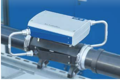
Figura 3.5: Caudalímetro AVL FlowsoniX Air Tabla 3.5: Especificaciones del caudalímetro AVL FlowsoniX Air
