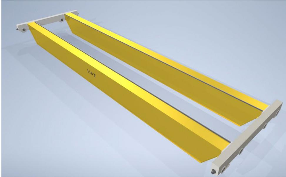
Figura 52. Ensamblaje de vigas principales y testeros . (Fuente: Elaboración propia)
