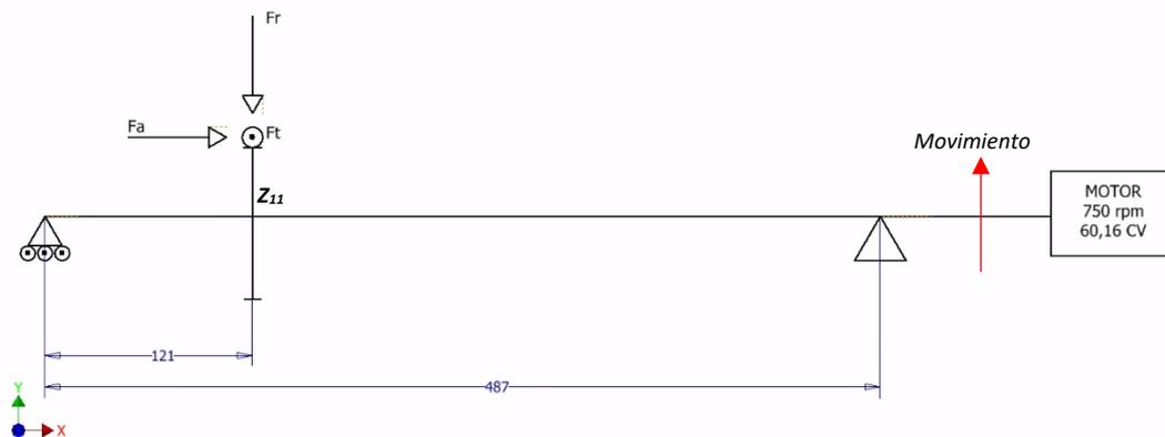
Figura 118. Fuerzas actuando sobre el eje de entrada. (Fuente: Elaboración propia)
