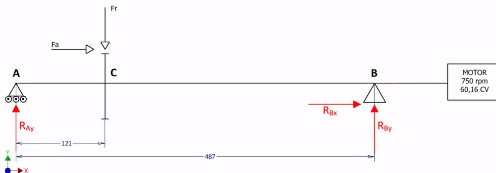
Figura 120. Reacciones en los apoyos, plano XY. (Fuente: Elaboración propia)
