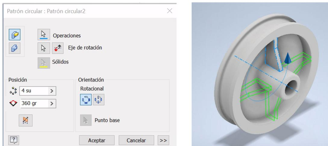
Figura 32. Operación de patrón circular para modelar los nervios de las ruedas. (Fuente: Elaboración propia)
