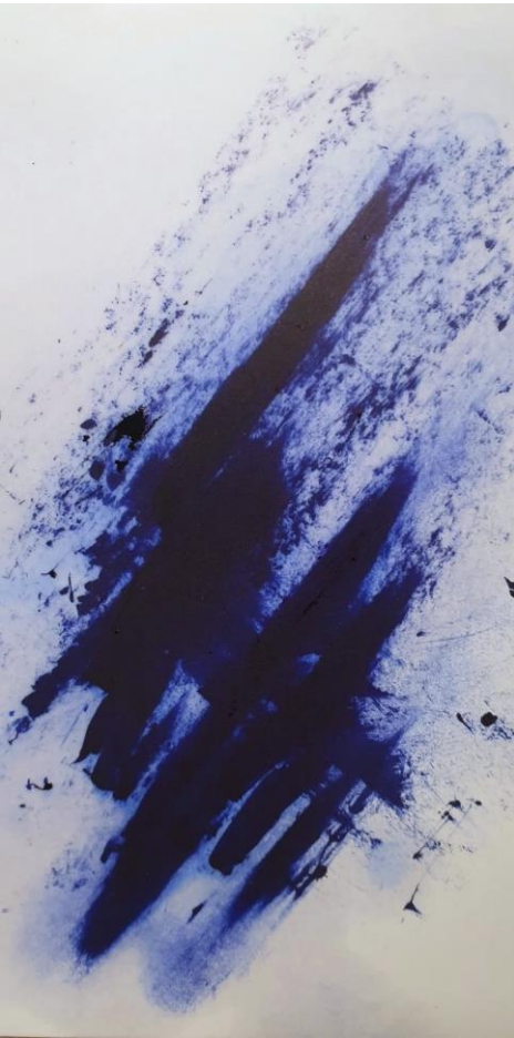
Fig. 83. Uno de los registros de tinta de bolígrafo tras una de las pruebas usando esencia de trementina y aceite de linaza como diluyentes
