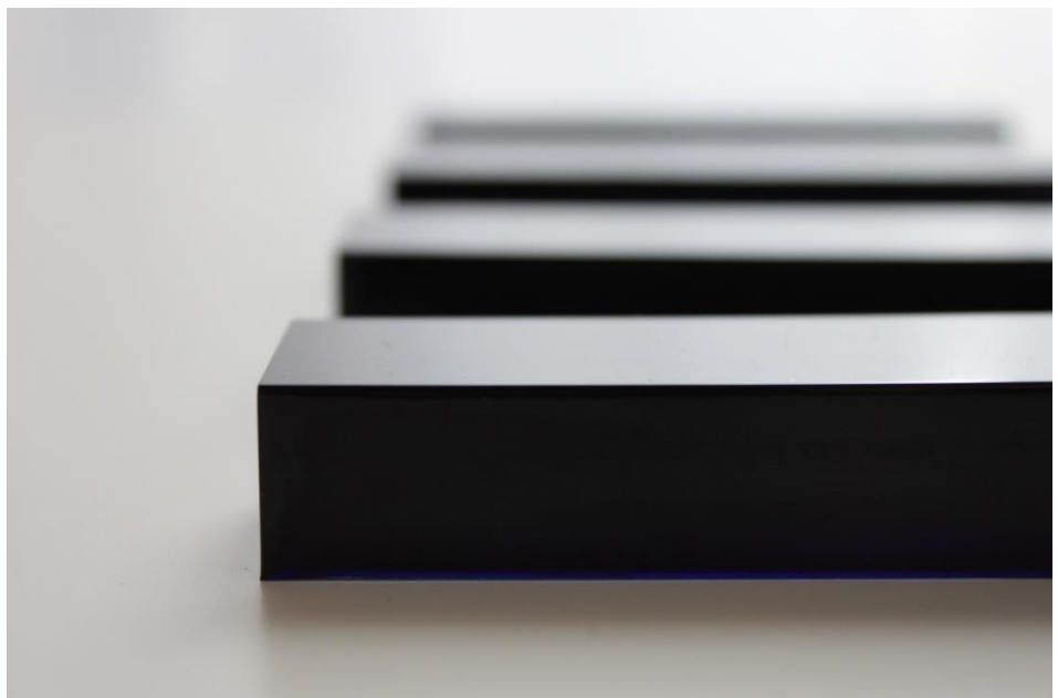
Fig. 86. Vista de detalle de las piezas resultantes una vez fraguada la resina y desmoldada
