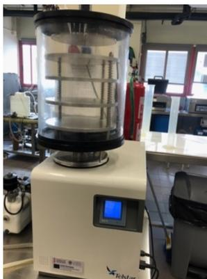
Figura 2. Liofilizador.
