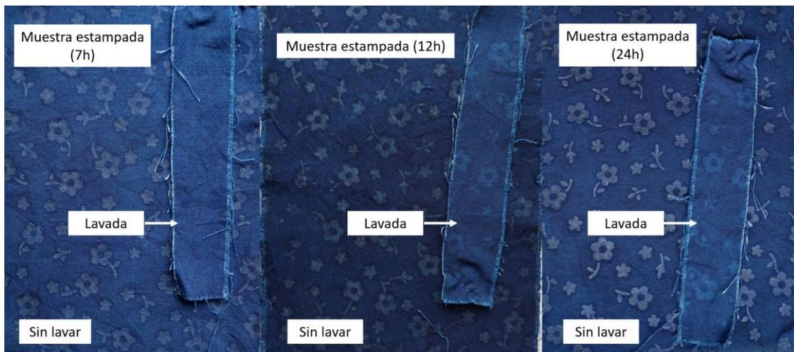
**Figura 48.** Muestras de tejido de calada 100% algodón tintadas con índigo (de izquierda a derecha): estampada con la Pasta de Estampación 1 e incubada 7 horas (lavada y sin lavar); estampada con la Pasta de Estampación 1 e incubada 12 horas (lavada y sin lavar); estampada con la Pasta de Estampación 1 e incubada 24 horas (lavada y sin lavar). (Fuente: **Propia**).
