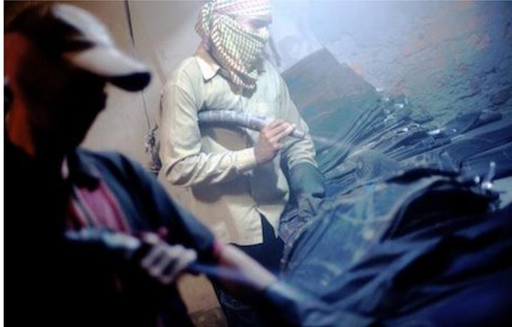
**Figura 3.** Método *sandblasting* para conseguir el efecto desgastado en prendas *denim*. (Fuente: **López, 2012**)
