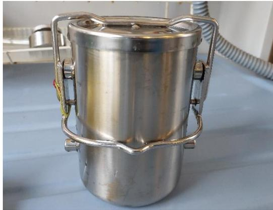
**Figura 24.** Recipiente en el que se introduce la muestra de tejido a decolorar enzimáticamente por agotamiento. (Fuente: **Propia**).
