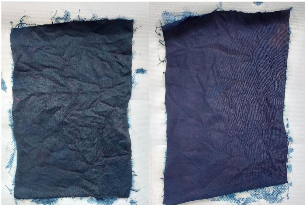
**Figura 32.** (Izquierda) Tejido con tono verde (tintura sin oxidar) recién sacado del baño de tintura. (Derecha) Tejido de color azul tras la oxidación del colorante sobre la fibra al contacto con el aire.
