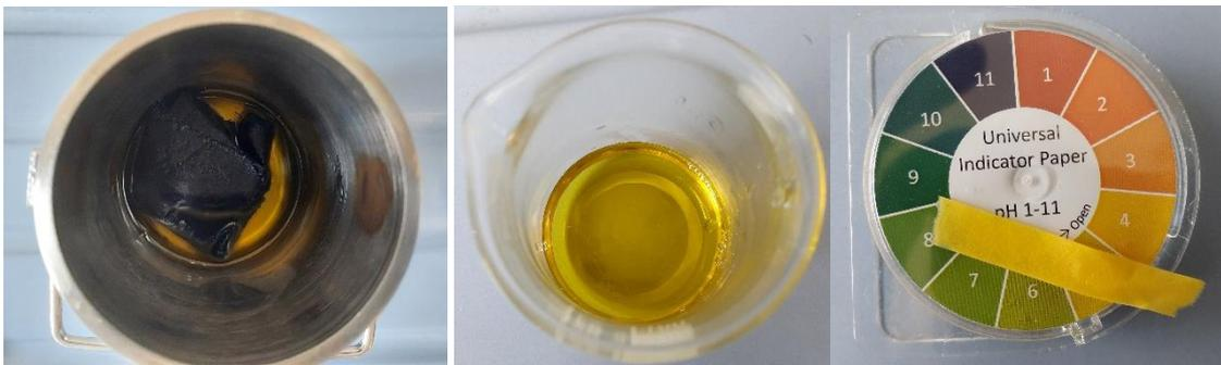
**Figura 39.** (Izquierda) Tejido y baño de agotamiento tras el tratamiento enzimático. (Centro) Baño de agotamiento extraído del recipiente para el proceso mencionado. (Derecha) pH del baño de agotamiento tras dicho tratamiento. (Fuente: **Propia**)
