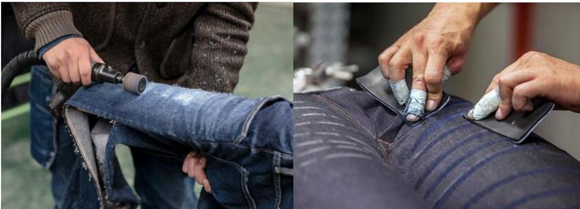
**Figura 4.** Métodos para conseguir el efecto de desgastado en prendas *denim*: (Izquierda) Métodos de pulido o cepillado mecánico (Fuente: **The Factory 8, 2018**). (Derecha) Métodos de pulido o cepillado manual (Fuente: **Demir, 2021**)
