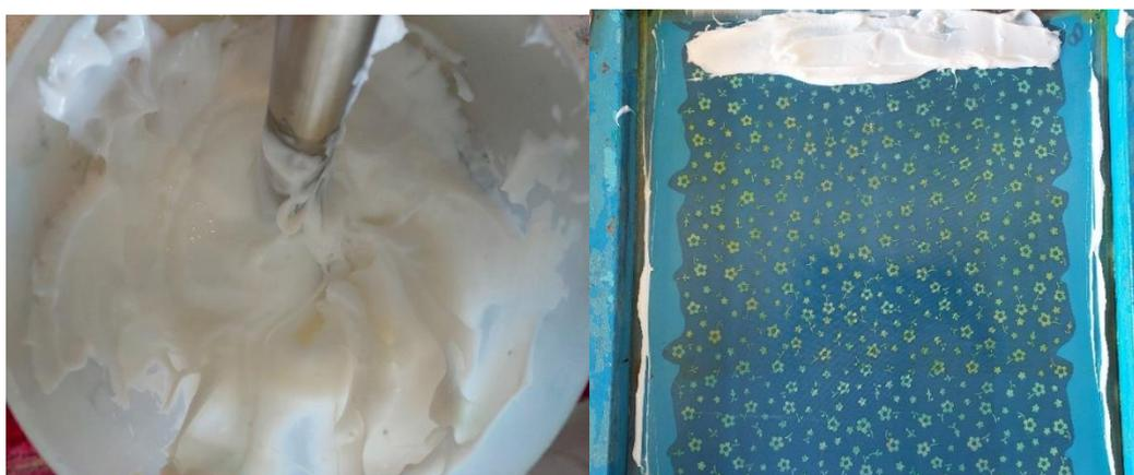
**Figura 25.** (Izquierda) Pasta de estampación. (Derecha) Marco de estampación colocado sobre el tejido y con la deposición de la pasta en la parte superior. (Fuente: **Propia**)
