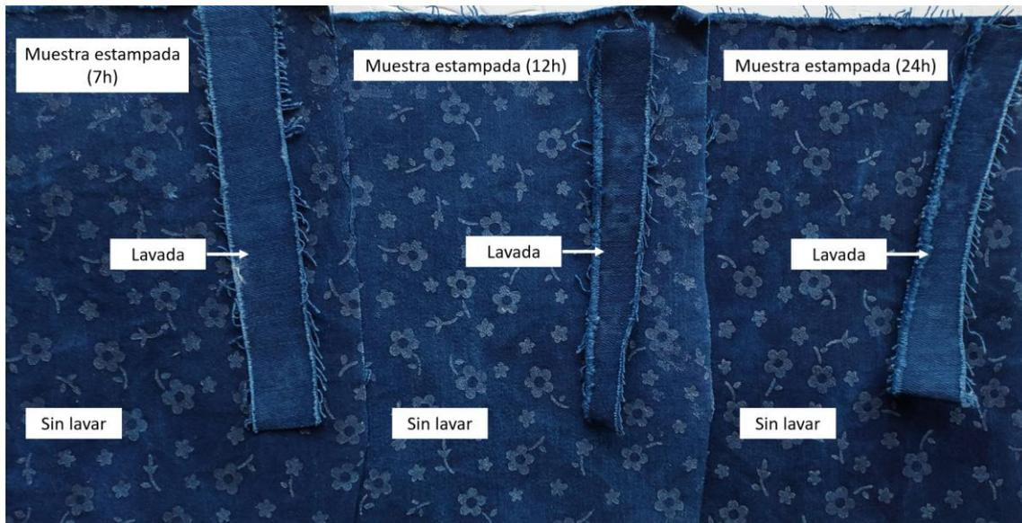
**Figura 49.** Muestras de tejido de calada 98% algodón/2% elastano tintadas con índigo (de izquierda a derecha): estampada con la Pasta de Estampación 1 e incubada 7 horas (lavada y sin lavar); estampada con la Pasta de Estampación 1 e incubada 12 horas (lavada y sin lavar); estampada con la Pasta de Estampación 1 e incubada 24 horas (lavada y sin lavar). (Fuente: **Propia**).
