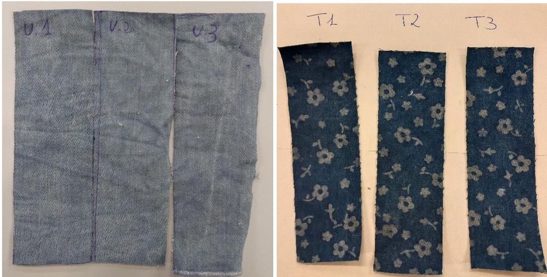
**Figura 28.** (Izquierda) Muestras de tejido 98% algodón/2% elastano tintado y cortado en sentido urdimbre (Derecha) Muestras de tejido 98% algodón/2% elastano tintado y estampado y cortado en sentido trama. (Fuente: **Propia**)
