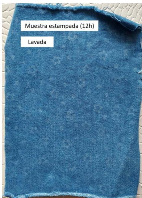
**Figura 58.** Muestra de tejido de calada 98% algodón/2% elastano tintada con índigo, estampada con la Pasta de Estampación Borato e incubada 12 horas: Lavada. (Fuente: **Propia**)
