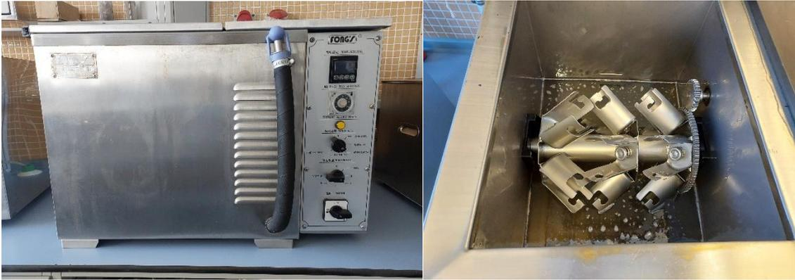
**Figura 23.** (Izquierda) Exterior máquina Linitest. (Derecha) Interior máquina Linitest. (Fuente: **Propia**)
