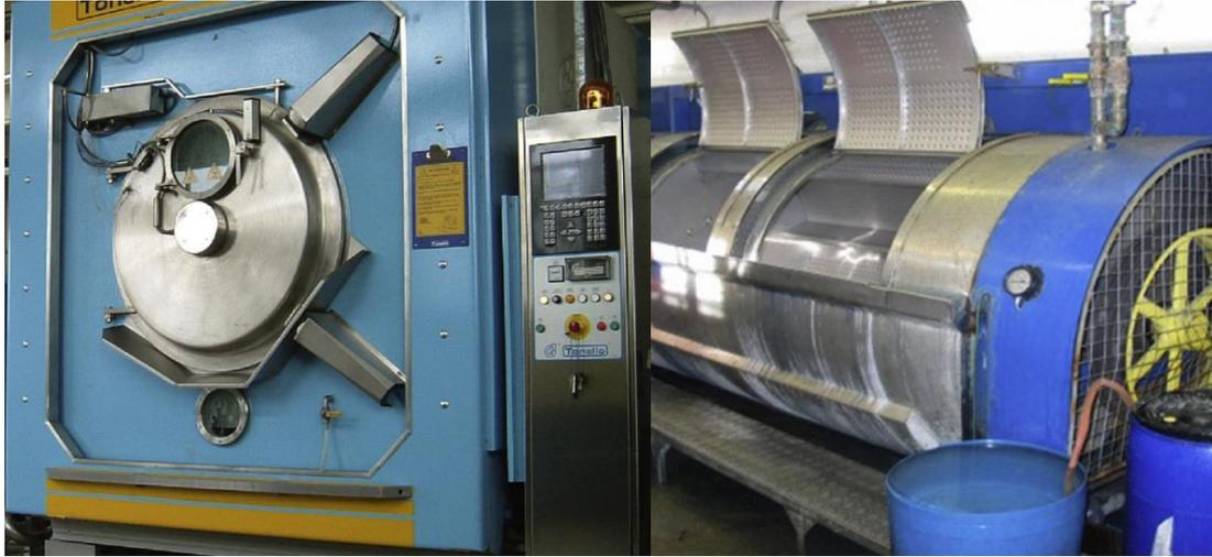
**Figura 2.** (Izquierda) Lavadoras utilizadas para tratamiento de tejido *denim* de carga frontal (Derecha) y lateral. (Fuente: **Colomera y Kuilderd, 2015**)
