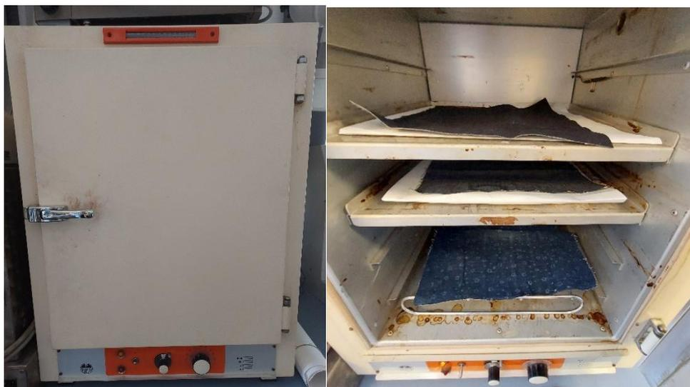
**Figura 26.** (Izquierda) Estufa de laboratorio para la incubación de muestras de tejido estampado. (Derecha) Muestras de tejido estampado incubadas en la estufa de laboratorio. (Fuente: **Propia**)
