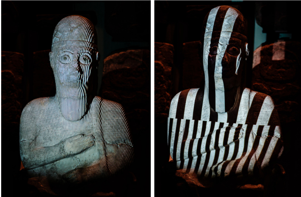
Ilustración 4. Ejemplo de uso de la técnica de luz estructurada
