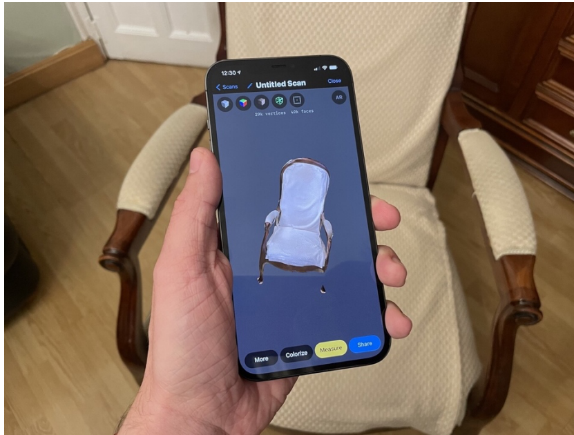
Ilustración 10. Ejemplo de reconstrucción con el dispositivo iPhone 13 Pro
