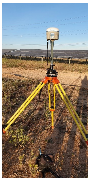
Figura 6. Receptor de Base fija montada
