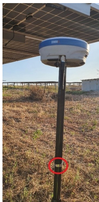
Figura 39. Abrazadera con púa en jalón
