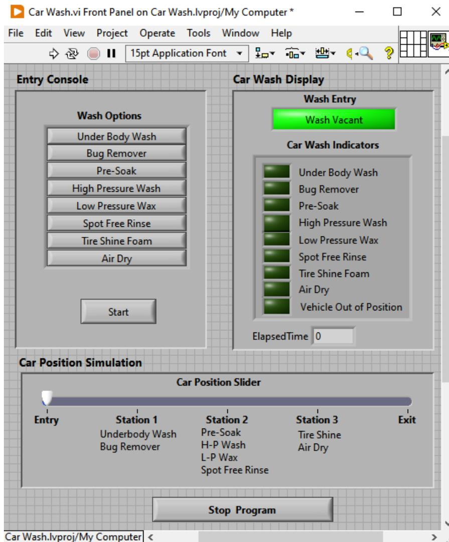
Figura 11 Ejemplo de Front Panel
