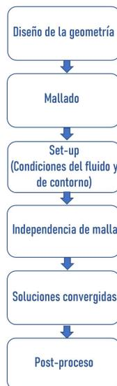
Figura 6.1: Proceso de simulación CFD
