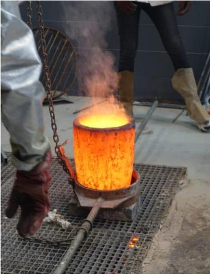
Fig. 33. Crisol de bronce salido del horno.
