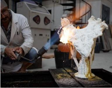
*Fig. 31. Descerado manual del molde de cascarilla cerámica.*
