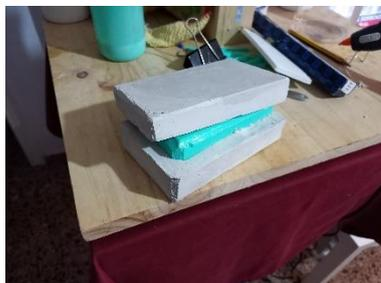
Fig. 24. Caja de escayola sobre el molde de silicona.
