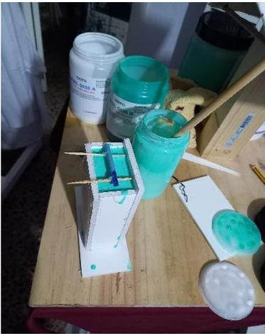
Fig. 23. Realización molde de silicona a partir de la figura original tallada en ceral.
