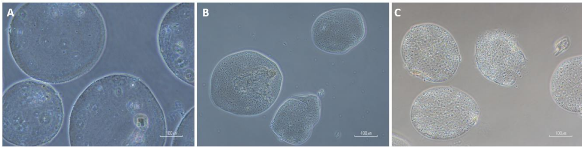
Figura 19. Microesferas de alginato-fibroína de seda: A) Tras su síntesis; B) Tras inducir la cristalización con etanol y EDC/NHS overnight; C) Tras inducir la cristalización con GA y Gly overnight. Barra de escala 100 \mu\text{m} .
