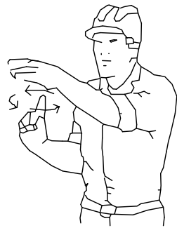
3 Levantar la carga lentamente
