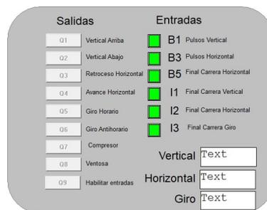
Imagen 12: Pantalla calibración brazo.
