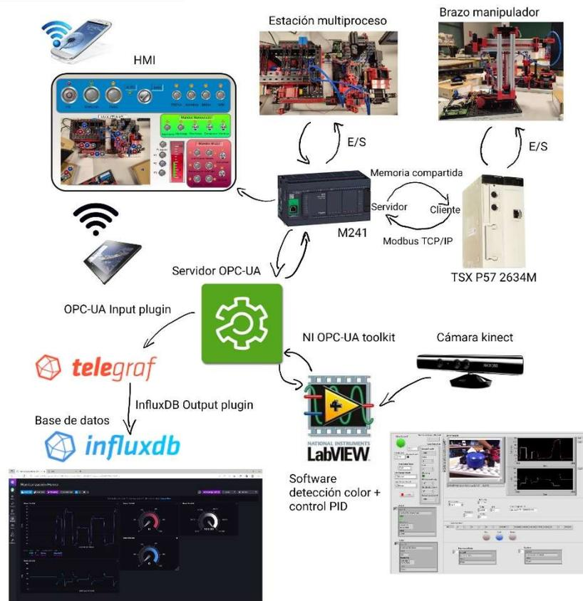
Imagen 24: Esquema conexión subsistemas. Fuente: Elaboración propia.
