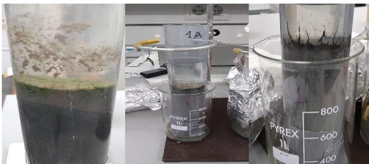
**Figura 26.** Imágenes de detalle de la evolución del sedimento a lo largo de la primera fase del ensayo en el punto 1. De izquierda a derecha: 1) Crecimiento de perifiton y tubificidos; 2) Inicio oxidación capa superficial (color marrón grisáceo claro); 3) Descomposición del perifiton (color ennegrecido en la superficie)
