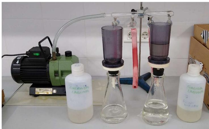
Fotografía 2. Sistema de filtración al vacío de las muestras.
